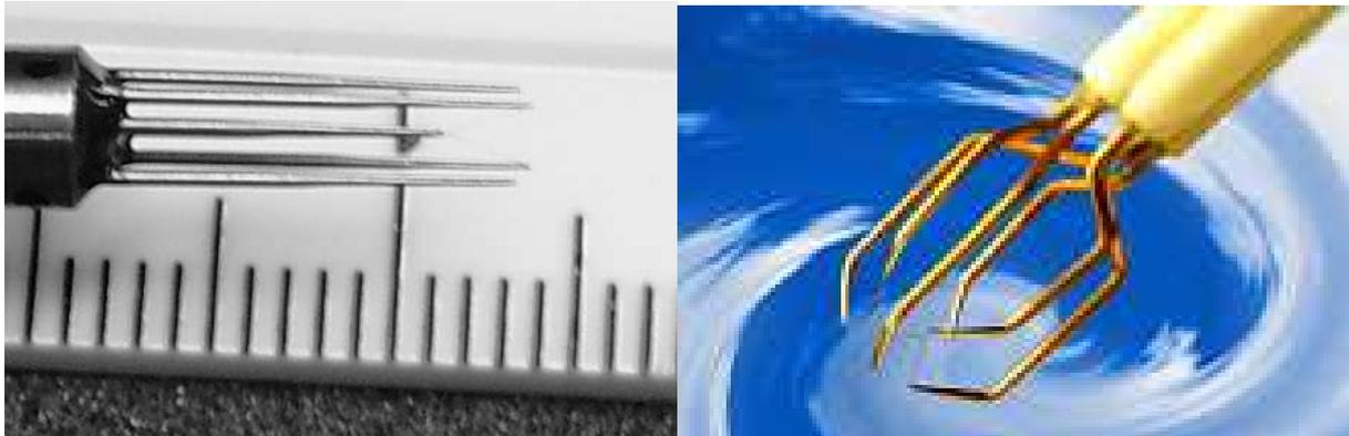
**Abb. A2.6: Dreifach-Hitzdrahtsonden von DANTEC DYNAMICS, Spezialanfertigung (links) und handelsübliche (rechts)**
