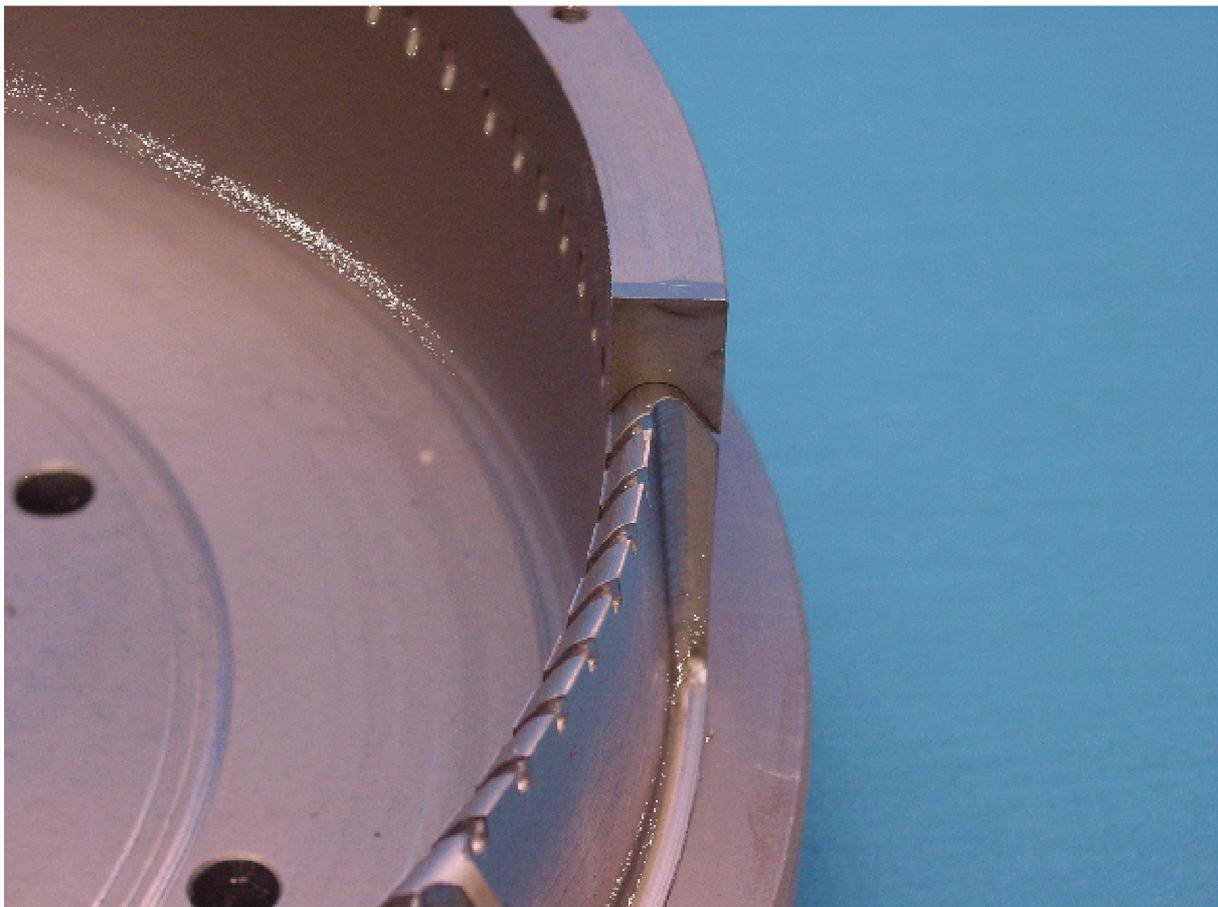
Bild 3.18: Teilringe mit Umlenkkontur, Sammelkammer mit Schlitzen
