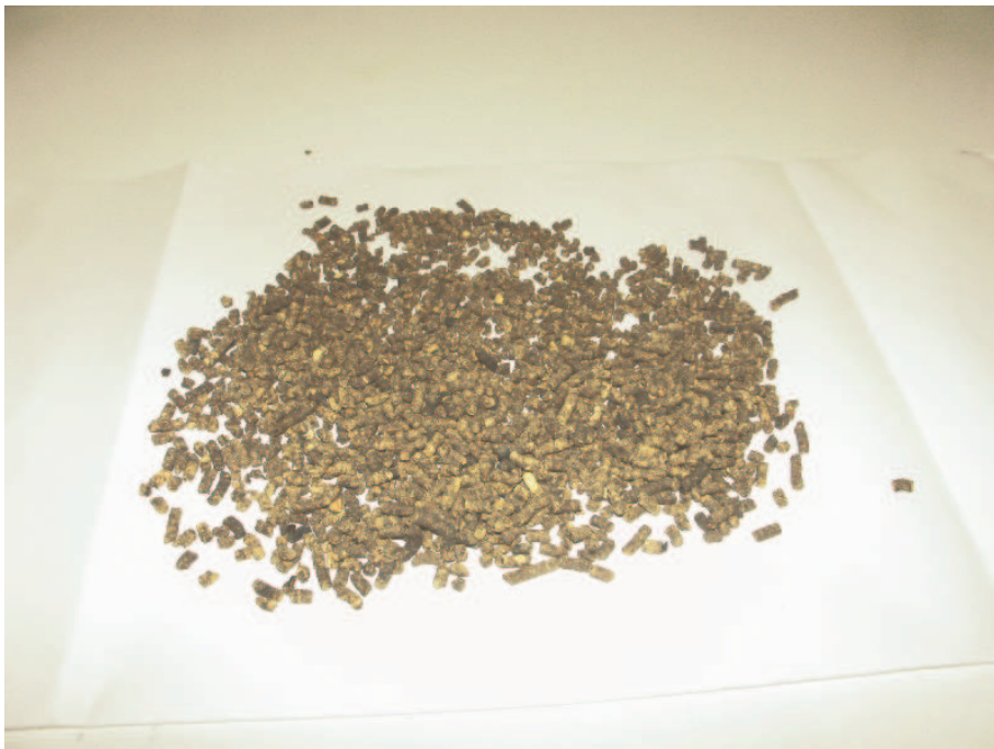
Abb. A7: Rhabarberwurzel- Pellets aus der Wirbelschichttrocknung
