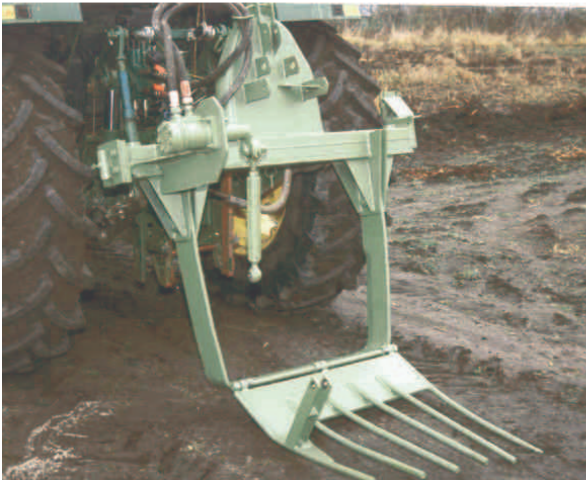
Abb. 5: Pflug zum Auspflügen der Wurzeln
