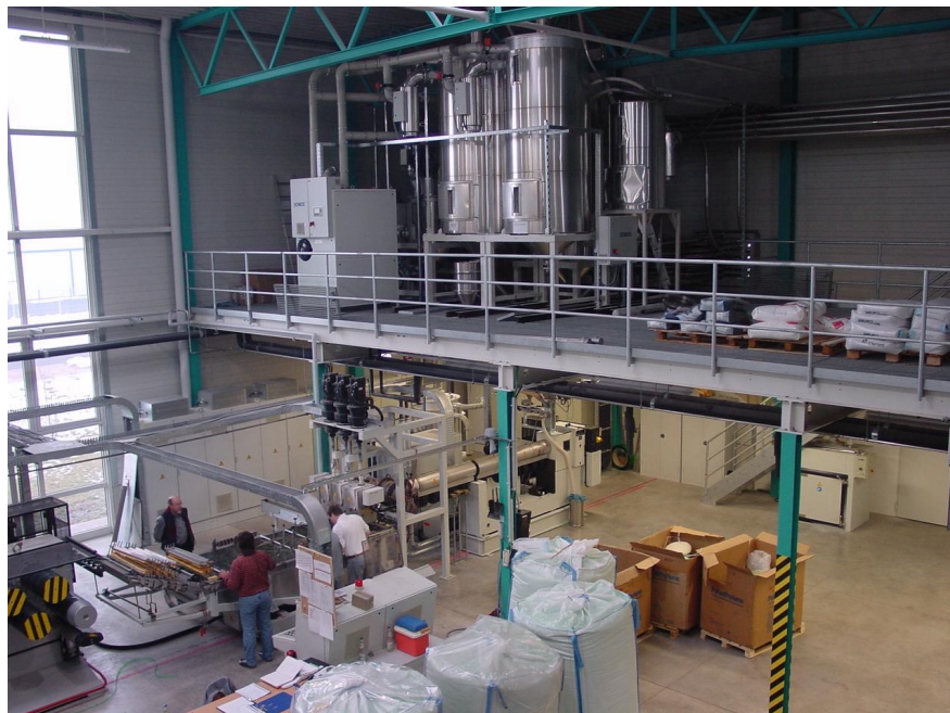
Abb. 5: Einschnecken-Extruder mit Kristallisator und Trockner
