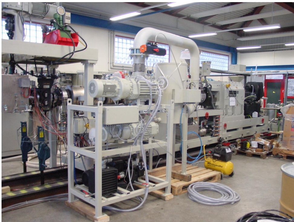
Abb. 7: 85 mm Doppelschnecke mit Vakuumpumpe und Siebwechsler
