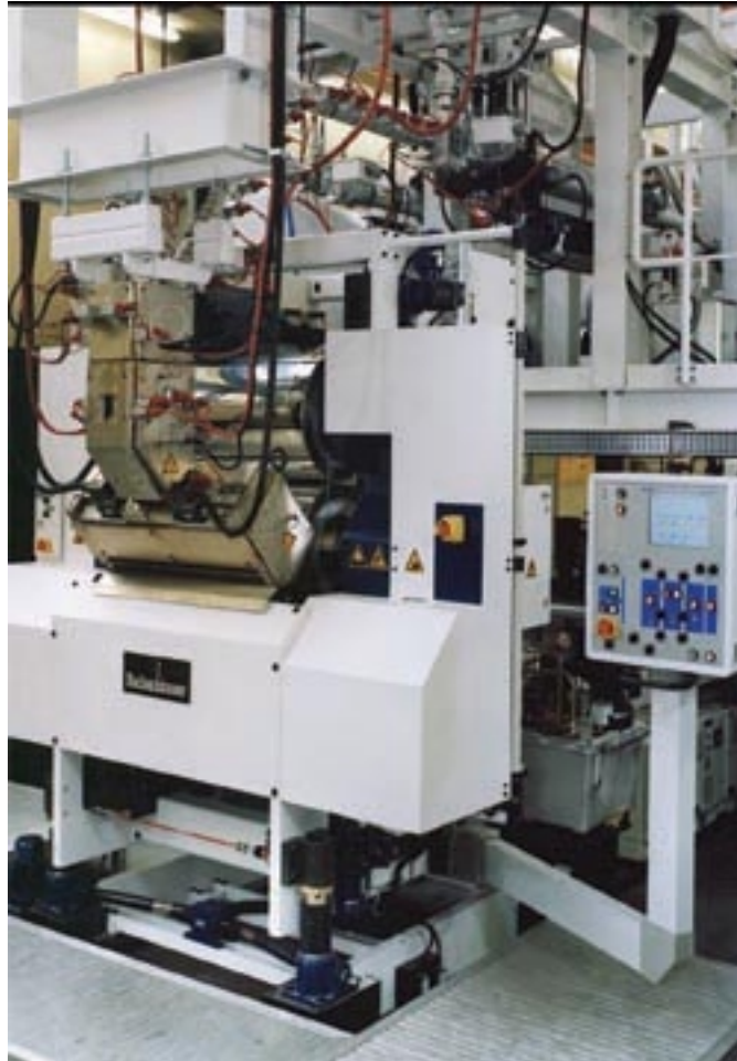
Abb. 9: Detail einer Tiefziehfolienanlage zur Herstellung von PET-Folien mit 3-Schicht-Coextrusionsadapter
