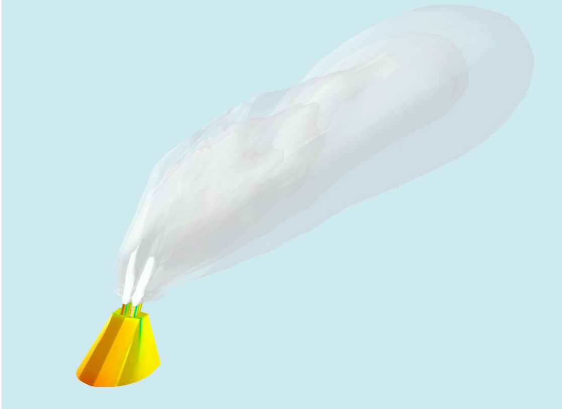
Abb.4.11: Rauchgasausbreitung am Schornstein auf Platte
