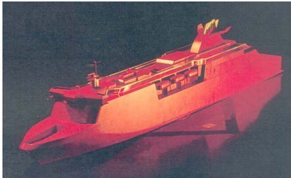
Abb.5.31: Modell im Windtunnel
