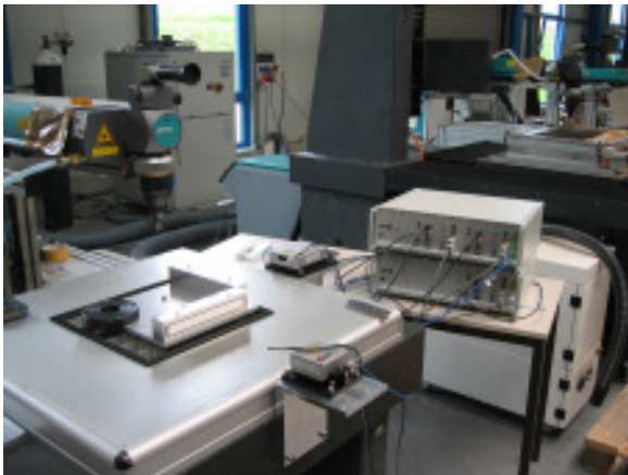
Bild 3: Interferometer die Firma SIOS Messtechnik GmbH, montiert am Planartisch PMS 200; kompletter Messaufbau Genauigkeit bis zu 10^{-8} , höchste Linearität einschließlich Temperaturkompensation
