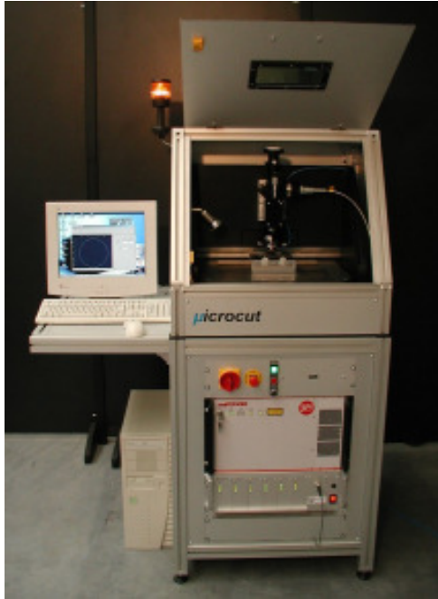
Bild 23: Kleinste Laser-Präzisionsschneidanlage der Welt mit integriertem Yb-Faserlaser
