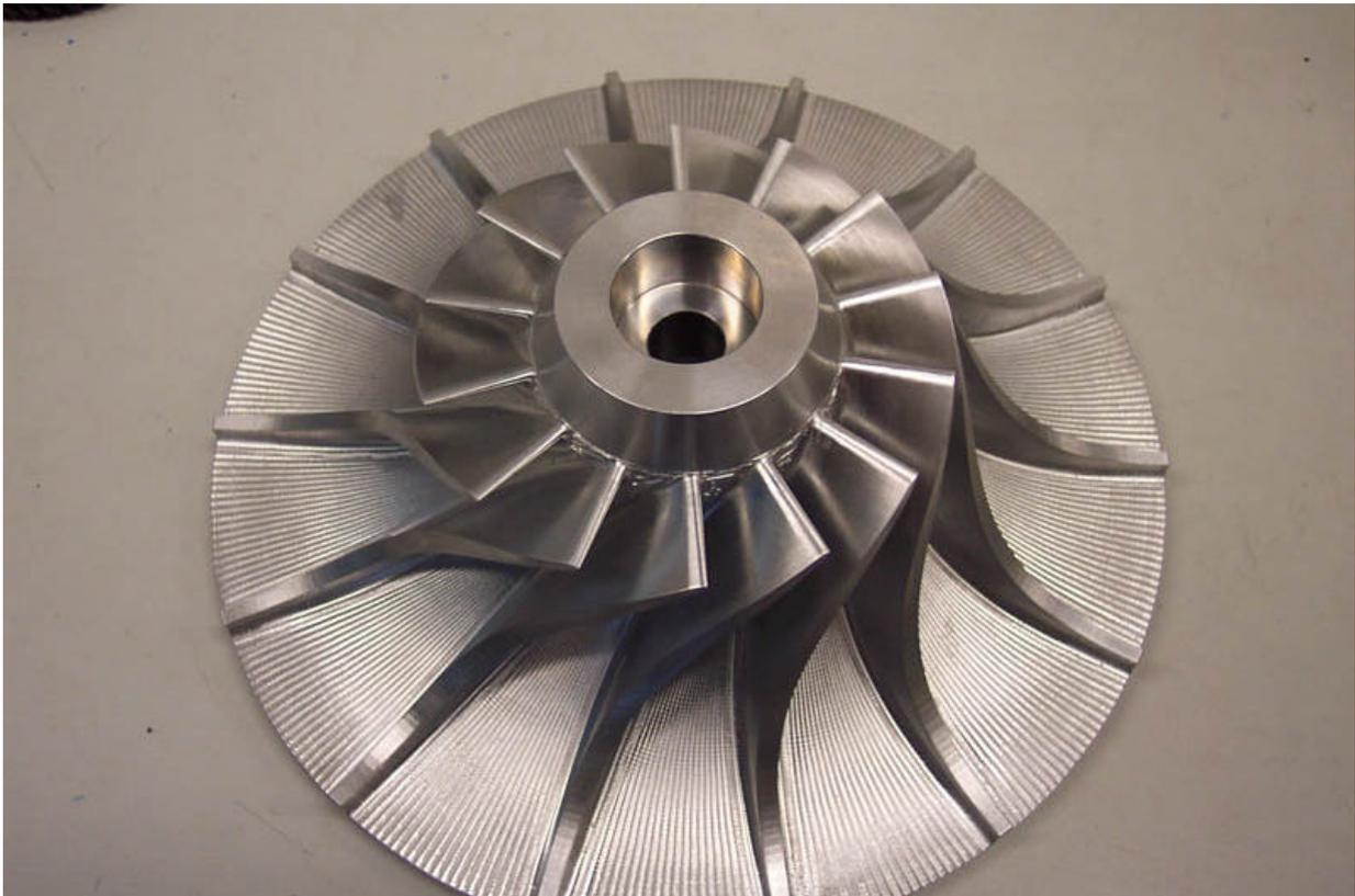
Abbildung 19: Impeller – Turbinenlaufrad aus Aluminium
