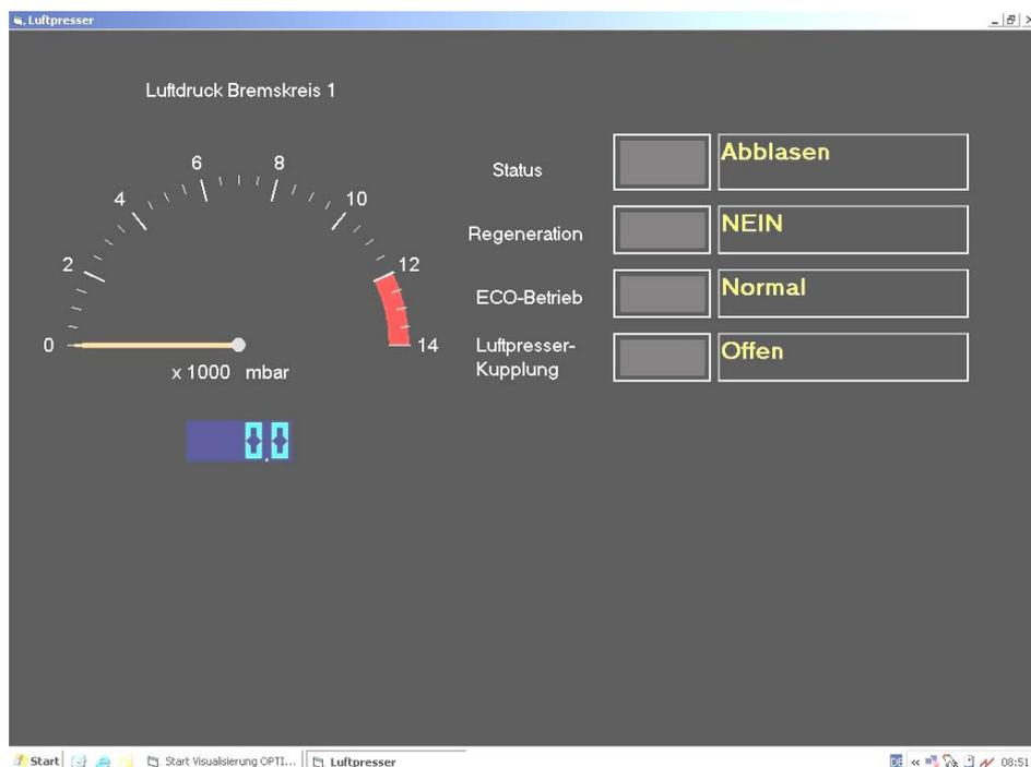
**Bild 36:** Zusätzliches Fahrer-Display: Druckluftsystem
