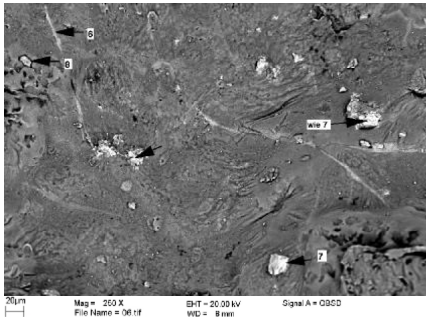
Abbildung 5: REM-Aufnahme einer Schaumprobe, 250-fache Vergrößerung, mit markierten Einschlüssen (6-8)
