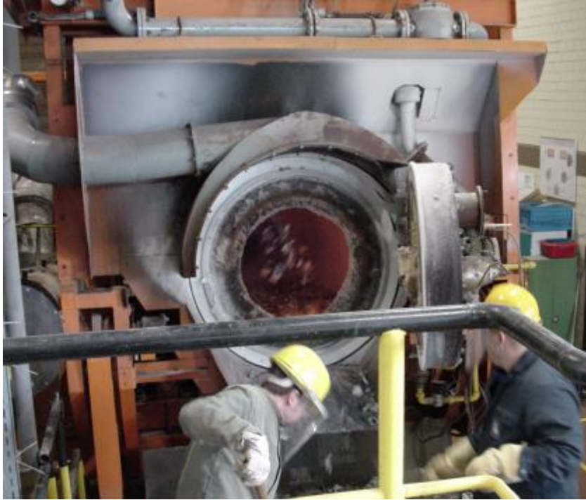
Abbildung 11: Pilot-Drehtrommelofen der F&E Bonn bei der Beschickung
