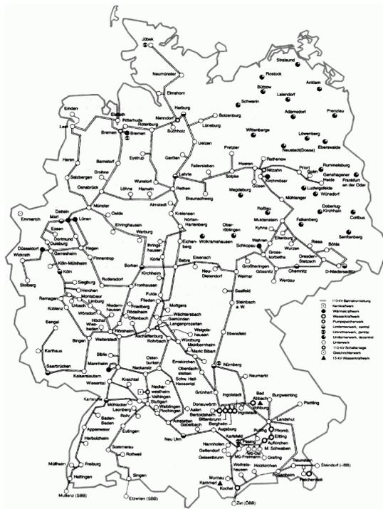
Bild 2-50 110-kV-Bahnstromverbundnetz der DB Energie
