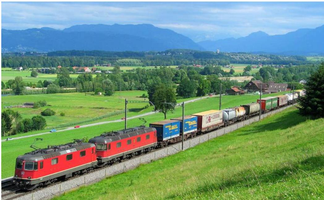
Bild 1-8: KLV-Zug mit Containern, Wechselbehältern und Sattelauflegern
