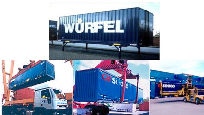
Bild 2-53 Wechselbehälter und Umschlag
