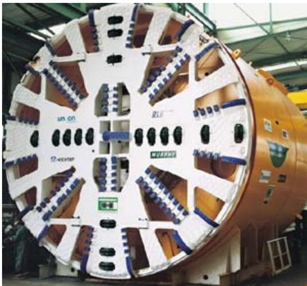
Bild 2-19: Mixschild  $\varnothing$  8160 mm [10]
