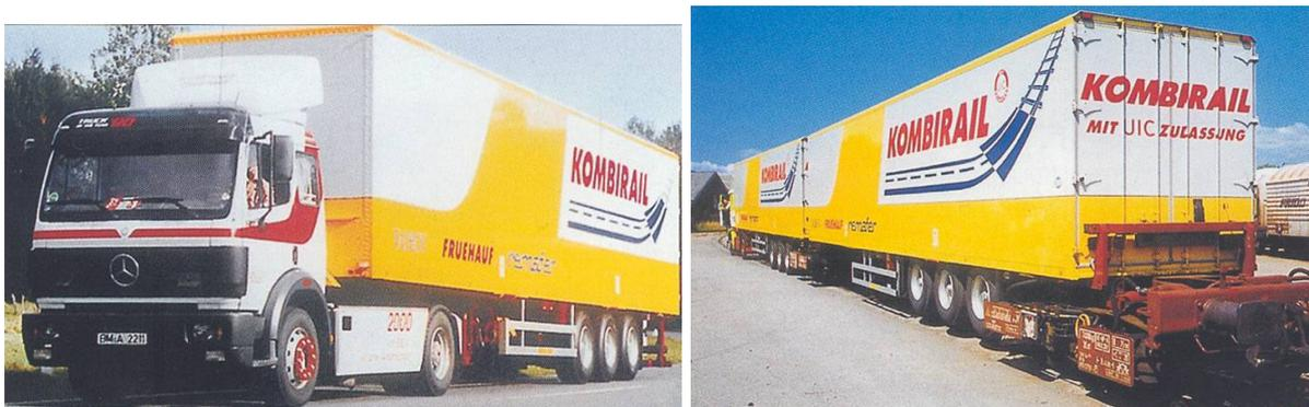
Bild 1-7: Sattelaufleger des Trailerzuges auf der Straße (l.) und auf der Schiene (r.)
