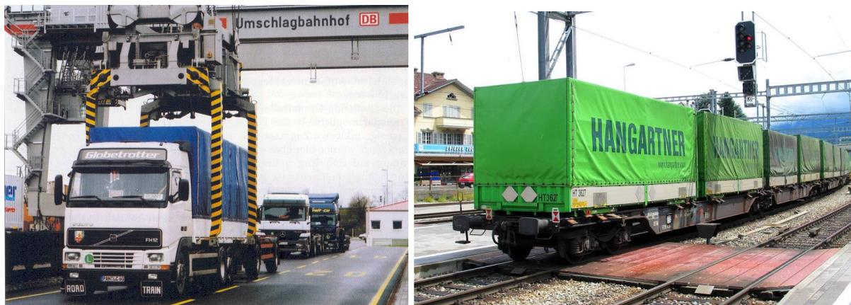
Bild 1-12: Wechselbrücken (LKW-Aufbauten) beim Umschlag (l.) und auf einem Eisenbahn-Tragwagen (r.)
