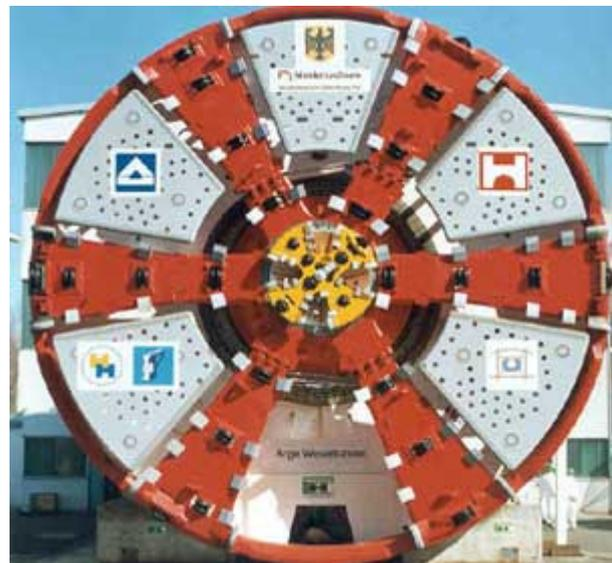
Bild 2-20: Mixschild  $\varnothing$  11670 mm [10]
