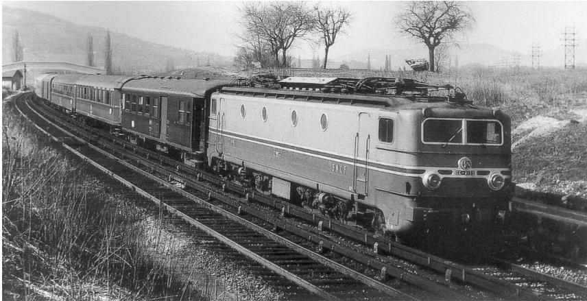
Bild 1-14: Lokomotive mit alternativer Stromabnahme aus dem Fahrdrabt oder aus einer Stromschiene, Mont Chenis (F) 1970
