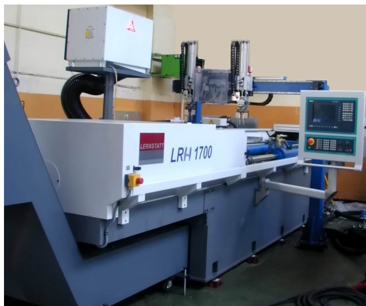
Abbildung 11: LERNSTATT Räummaschine zur Herstellung von Zahnrädern
