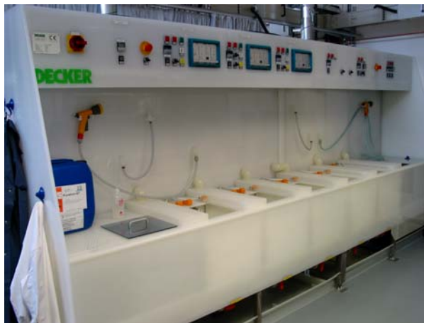
Abbildung 18: Reinigungsstrecke der Firma Decker. Die Wafer werden von links nach rechts durch insgesamt 7 Becken geführt, bevor der Reinigungs- und Trocknungsprozess abgeschlossen ist.
