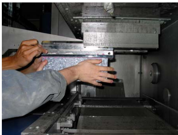
Abbildung 16: Einbau des zu schneidenden Siliciumkristalls in die Vorschubeinheit. Das Silicium wird von oben auf das Drahtfeld gedrückt.
