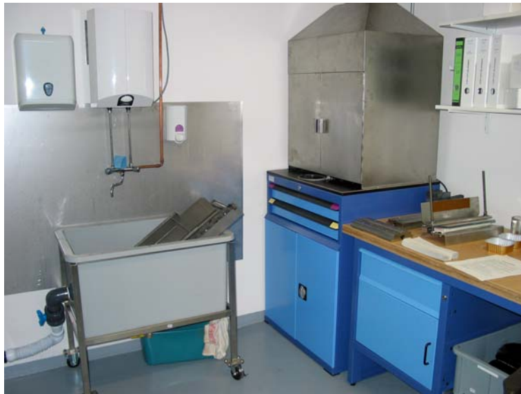
Abbildung 13: Klebe- und Ablösestation, bestehend aus Abspülbecken (zur manuellen Vereinzelung, links im Bild), Hotplate mit Absaugung (zur Kleberlösung, mit Edelstahleinhausung) sowie Werkbank mit Klebe-Schraubzwinde.
