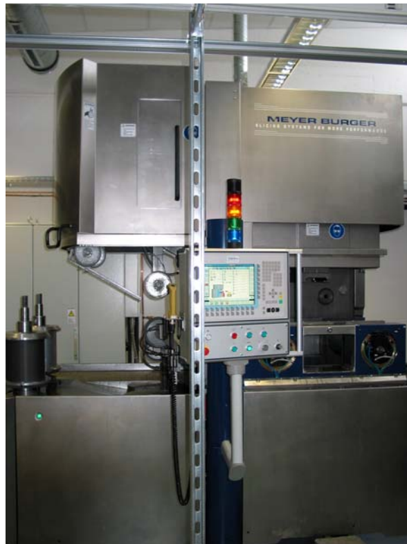
Abbildung 15: Drahtsäge Meyer+Burger DS-265. Im Vordergrund ist das Bedienpaneel zu erkennen. Am linken Rand sind die beiden Drahtspulen und die Umlenkrollen des Drahtspannsystems zu sehen. Auf der rechten Seite befindet sich der Prozessraum, in dem der eigentliche Schneidprozess stattfindet. Im Experiment sind die beiden Schutzhauben geschlossen, um ein Herausschleudern von Teilen und Slurry zu verhindern.
