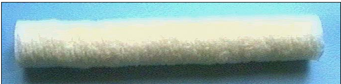
Abbildung 9: Fehler: Ungleichmäßige Oberfläche
