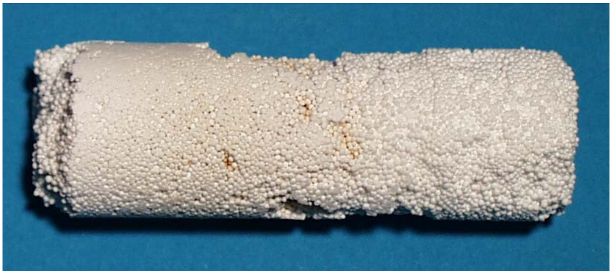
Abbildung 42: Formteil aus Stärkegranulaten ungekleisterter Stärke mit Zucker (Mikrowelle 2) gleichmäßigere Energieverteilung ermöglicht größere Formen
