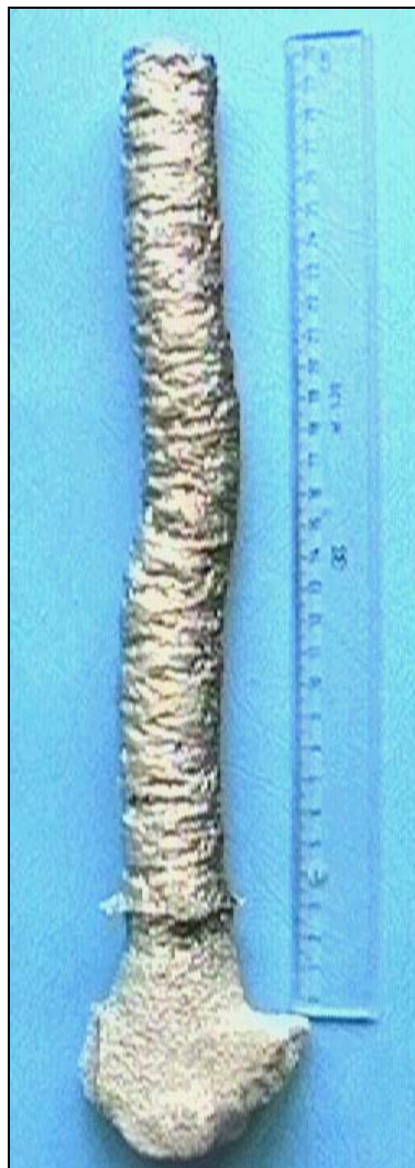
Abbildung 6: Niederdruckguß, Aluminium, V= 212 \text{ cm}^3
