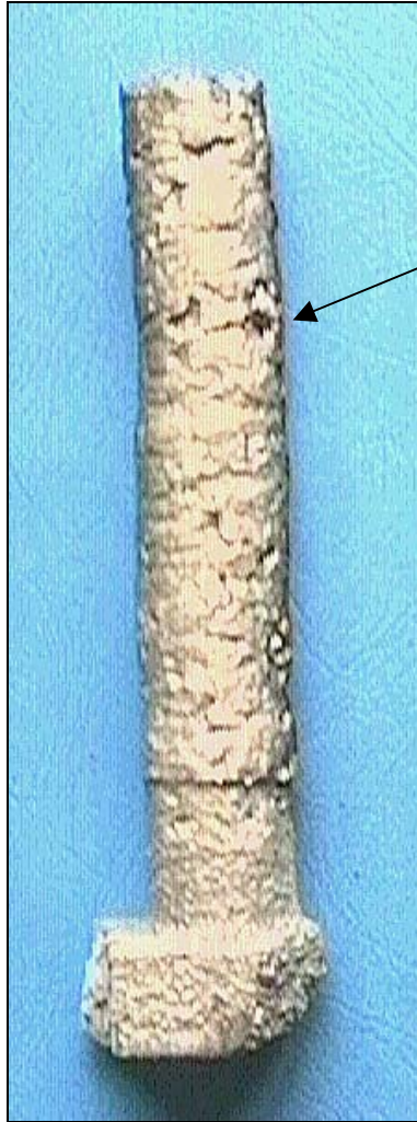
Abbildung 3: Gußstück mit gefurchter Oberfläche als Abbildung der gefurchten Oberfläche des Stärkemodells, Aluminium
