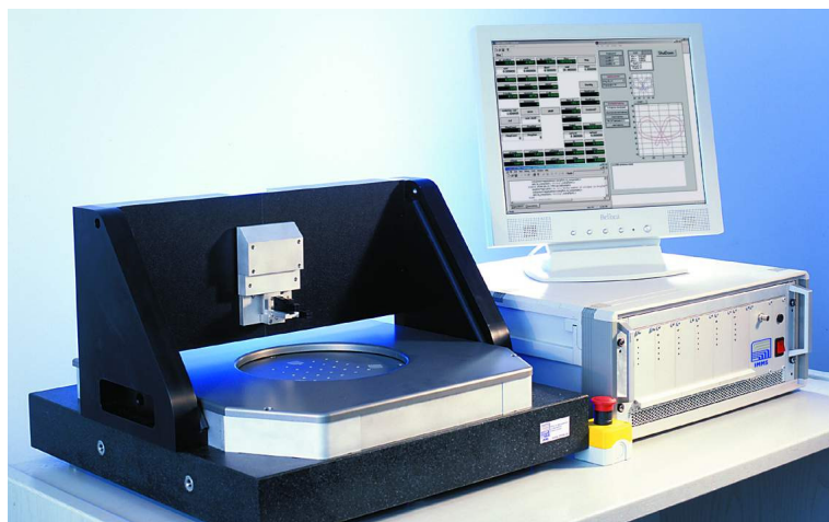
Abb. 6: PMS 100 - 3, Beispielapplikation aus der Oberflächenmesstechnik
