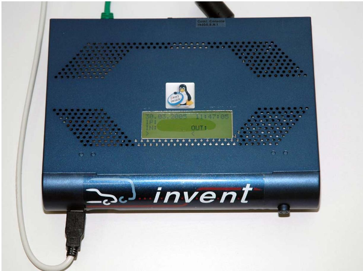
*Abbildung 20: ISDN-Router des ifak zur Datenanbindung an die SBA der UZ Börde*
