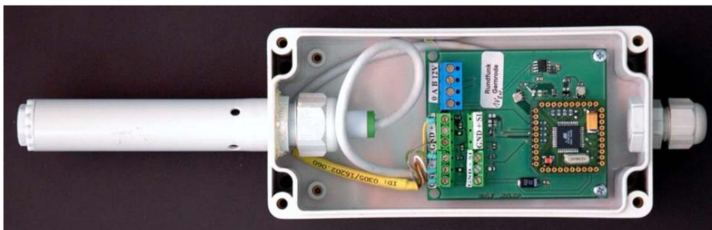
Abbildung 27: Prototyp des universellen Umweltsensors des ifak
