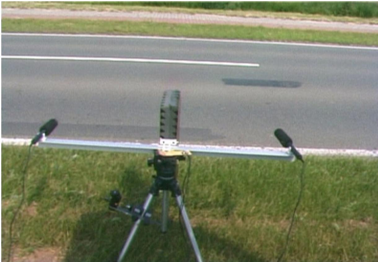
*Abbildung 29: Beispielanordnung von zwei Mikrofonen quer zur Richtungsfahrbahn*
