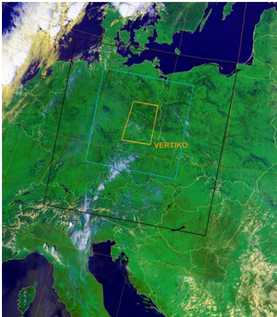
Abbildung 3: Rechengebiete des Lokal Modells und VERTIKO Untersuchungsgebiet (orange) Schwarz: im Projekt verwendetes Rechengebiet, 128x128 Gitterpunkte Blau: verkleinertes Rechengebiet für den Vergleich der unterschiedlichen Modellauflösungen, 80x80 Gitterpunkte
