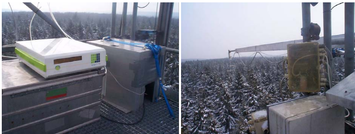
Abb. 5: Eddy-Kovarianz System für NH 3 -Flussmessungen im Solling.
