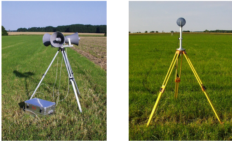
Abb. 4: Links: als Schallsender verwendete Druckkammerlautsprecher, um in alle Raumrichtungen gleichmäßig abstrahlen zu können, wurden drei Lautsprecher auf einem Universalstativ angebracht; rechts: Messmikrofon mit Windschutz, ebenfalls auf einem Stativ in 2 m über Grund.
