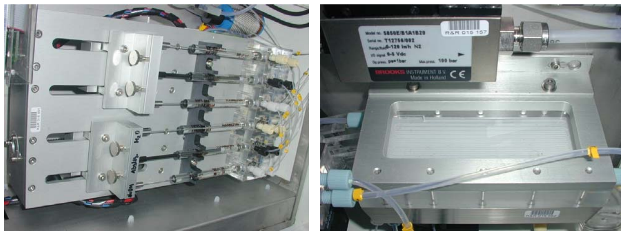
Abb. 8: Ammoniakmesssystem „AiRRmonia“, links Spritzenpumpe, rechts Kanalsystem (Denuder) mit Teflonmembran
