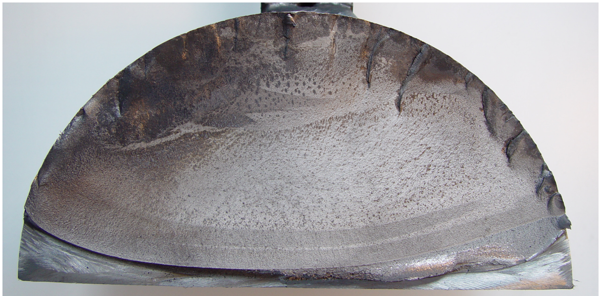
Bild A—50: Bruchfläche der Prüfwelle PD 70 (Versuchsreihe Presssitz, Werkstoff 34CrNiMo6) 2.067.000 Lastwechsel bei 175 MPa (Nennspannung), Blick auf sitzseitige Bruchfläche
