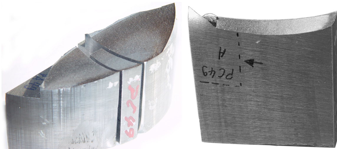
Bild A—56: Übersicht zu Probenentnahme und Schliffrichtung an Radsatz PC49 (Versuchsreihe A5T – Presssitz)
