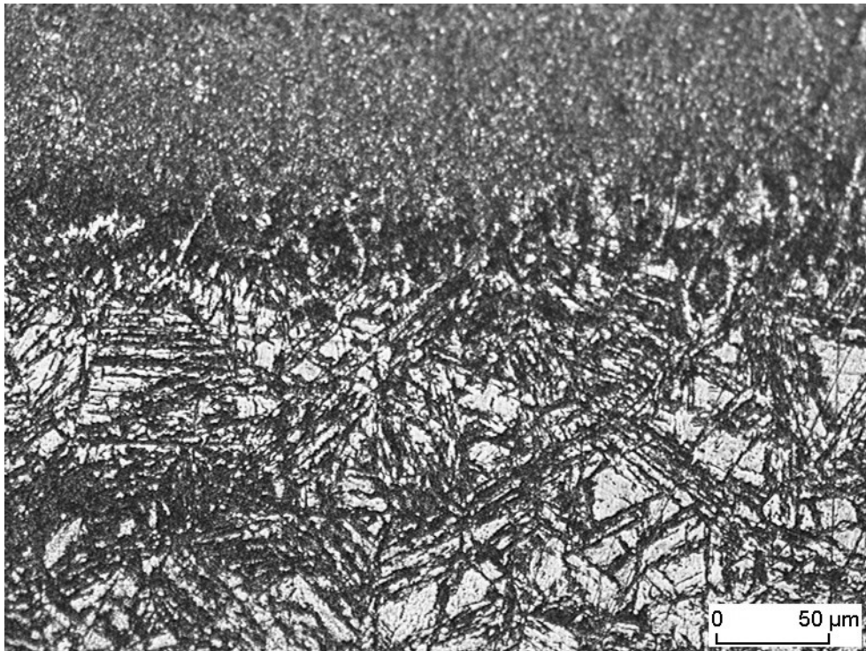
Bild A—55: Gefügebild von Radsatzwelle OC63 (Versuchsreihe A5T – Freie Oberfläche) mit martensitischem Bereich (untere Bildhälfte)
