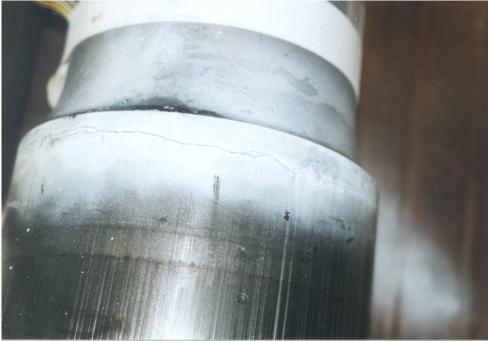
Bild A—53: Magnetpulverprüfung von Riss im Sitz der Prüfwellen OD86 (Versuchsreihe Freie Oberfläche, Werkstoff 34CrNiMo6), 2.200.000 Lastwechsel bei 183 MPa (Nennspannungsamplitude im Sitz)
