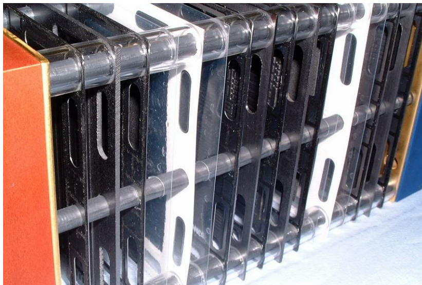
Abbildung 22: Expandiertes Modell eines Brennstoffzellenstacks
