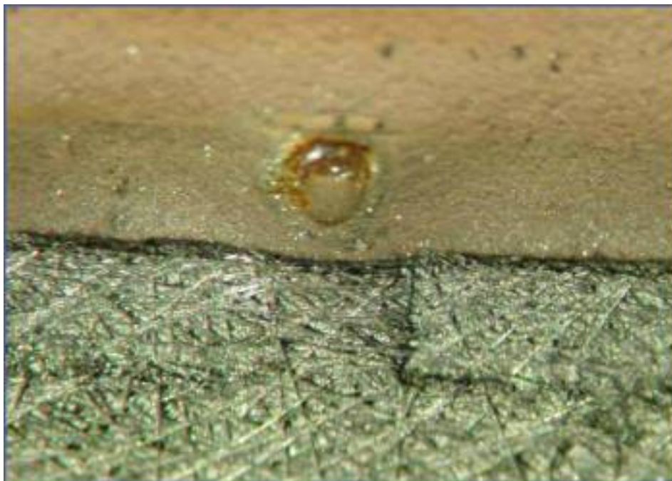
Abbildung 10: Kathodenseitige Anschmelzung im nicht aktiven Bereich einer Nafion 117-Folie.
