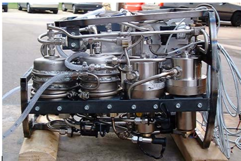
Abbildung 40: Funktionsfähiges Brennstoffzellenmodul im Stahlrahmen.
