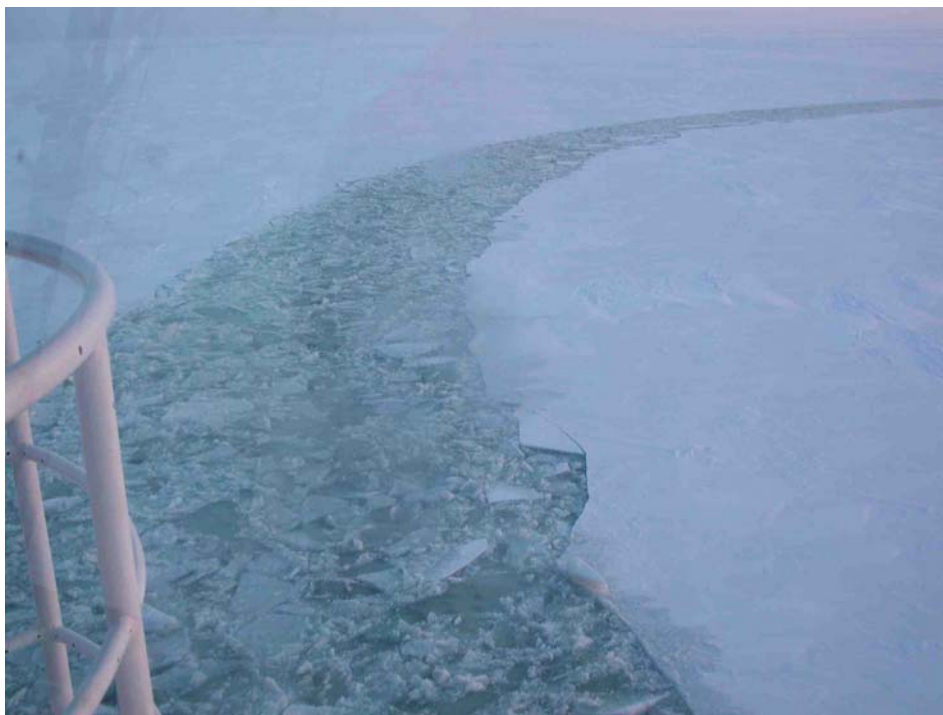
eine von der Maria S. Merian gebrochene kreisförmige Rinne mit scharfen Kanten
