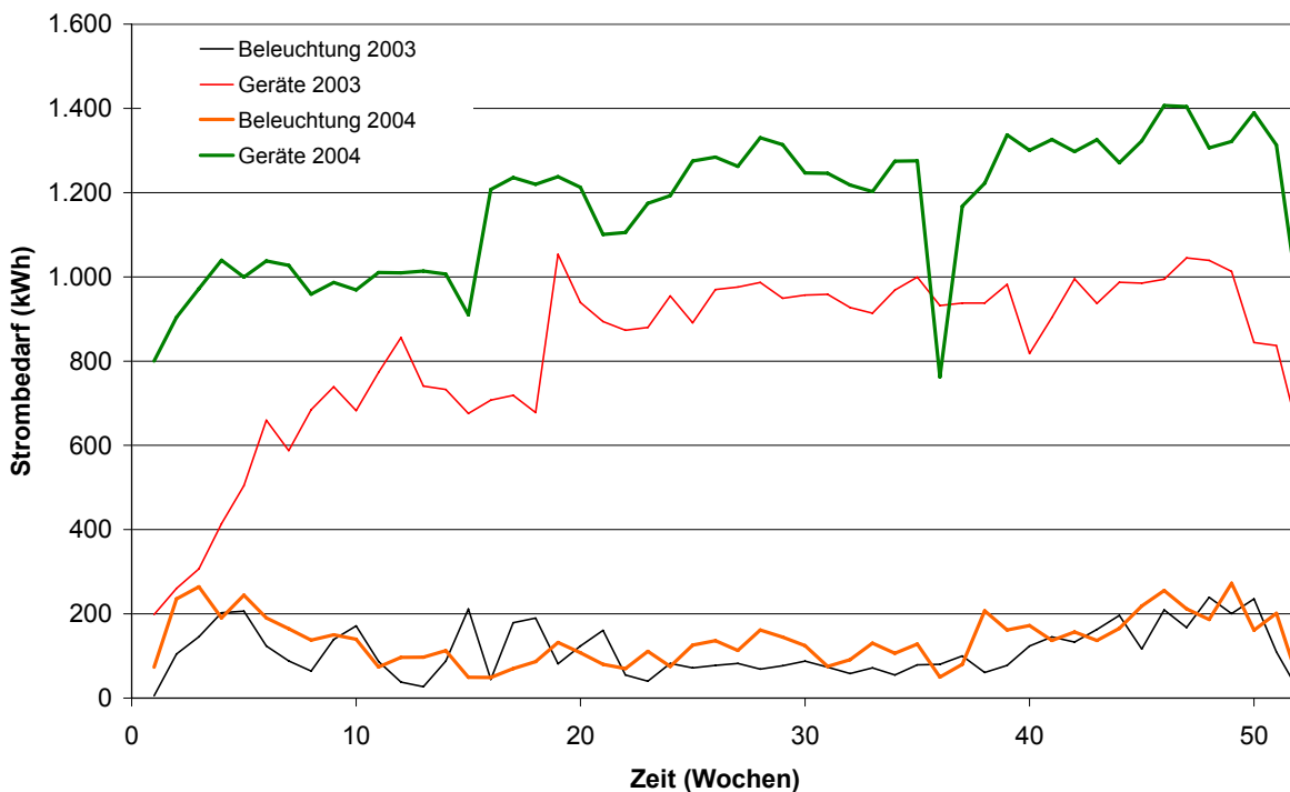
Bild 8.4: Strombedarf der Büroflügel für 2003 und 2004 (ohne Lüftung).
