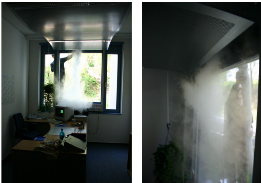
Bild 10.26: Der Nebelversuch wurde am 27.04.2004 zwischen 12:30 Uhr und 13:00 Uhr im Büro des Hausmeisters bei einer Innentemperatur von 24°C und einer Außentemperatur von 19,5°C durchgeführt. Die Photographien wurden beide ca. 5 sec nach Beginn der Nebelausbringung aufgenommen.
