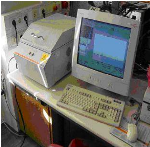
Bild 6: Spektrometer zum Auffinden von Metallpartikeln in der Lösung nach der 3-monatigen Testphase
