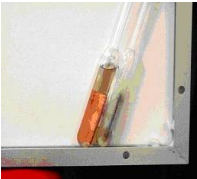
Bild 1: Probeneinschluss in Teströhrchen, Kupfer links, Eisen rechts
