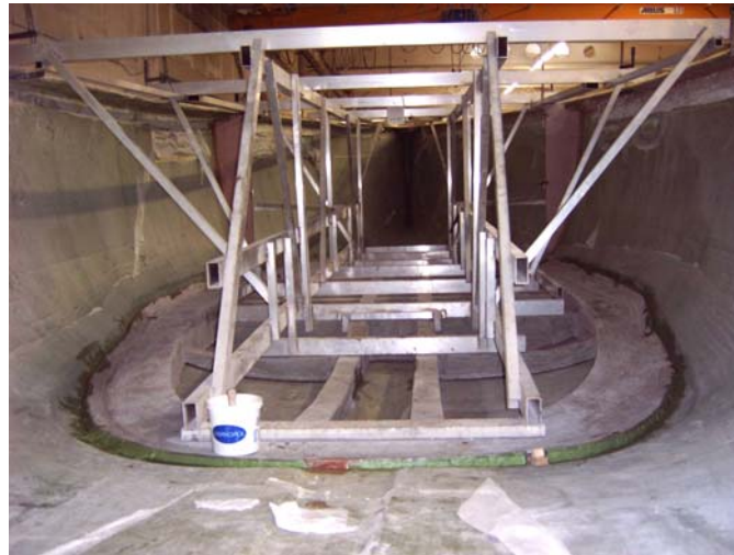
Abbildung 10: Herausquellender Klebstoff an der Verbindung Ruchgrat-Rumpf unter der Andrückvorrichtung nach [25]
