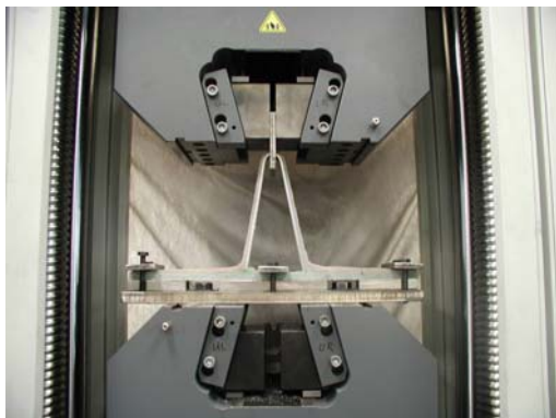
Abbildung 46: Versuchsaufbau: die Bauteilprobe in der Prüfmaschine
