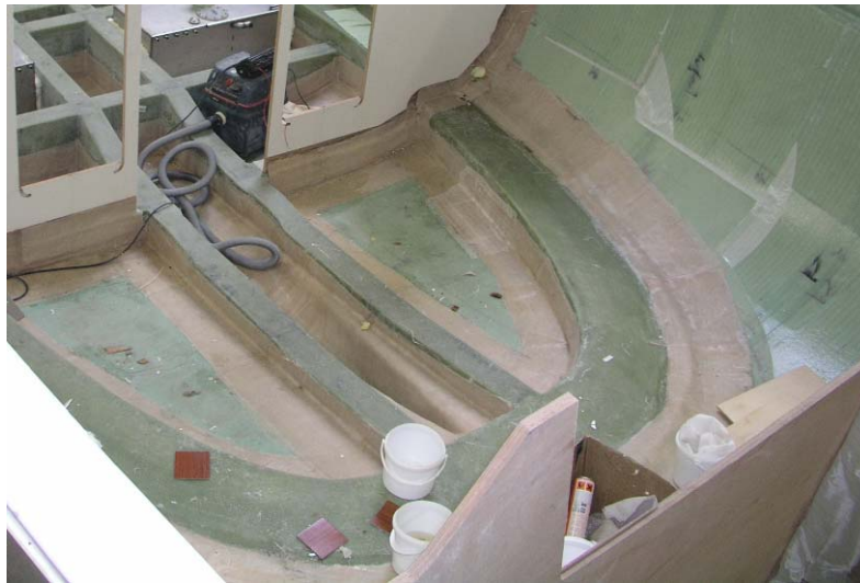
Abbildung 8: Einlaminiertes Rückgrat in den GFK - Rumpf
