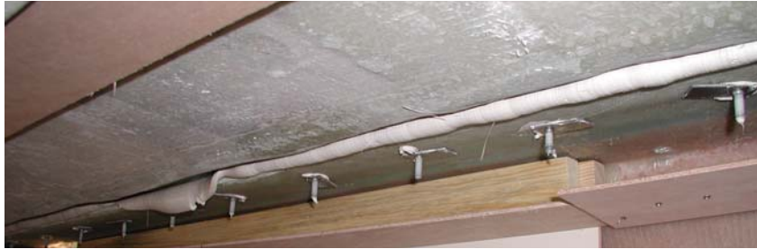
Abbildung 91: konstruktive Deck-Rumpf-Verbindung mit Durchgangsschrauben und Gewindeplättchen)
