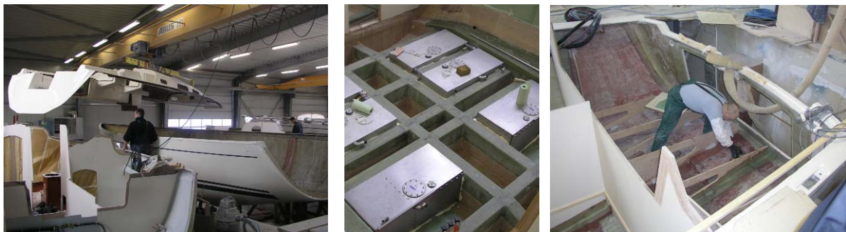
Abbildung 1: Serienfertigung von Yachten mit Längen zwischen 10 – 15 m, Einlaminieretes Rückgrat aus GFK, Laminieren von Elementen des Rückgrates
