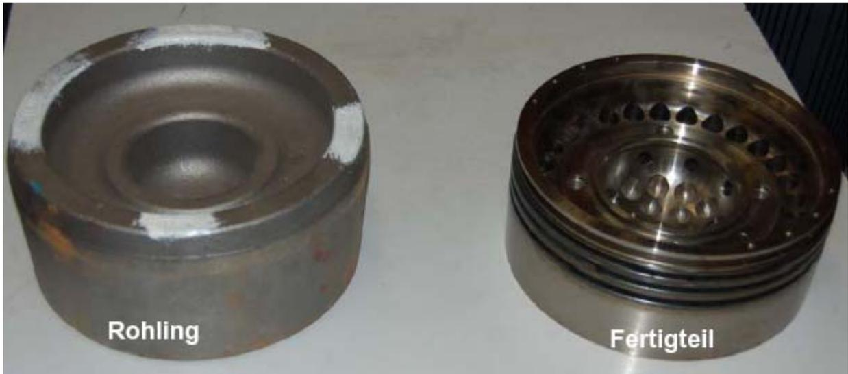
Abbildung 13: Kolbenoberteil
