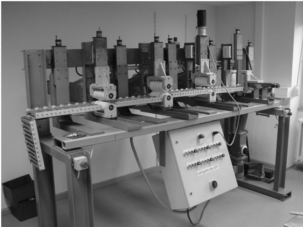
Bild 4: Plastilin-Modellwalzwerk [IBF - RWTH Aachen]
