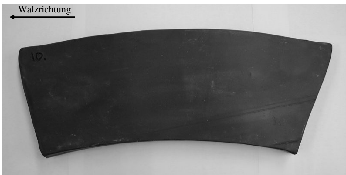
Bild 21: Typische beim Walzen mit geschwenkten Walzen und ohne Seitenführungen generierte Probenform
