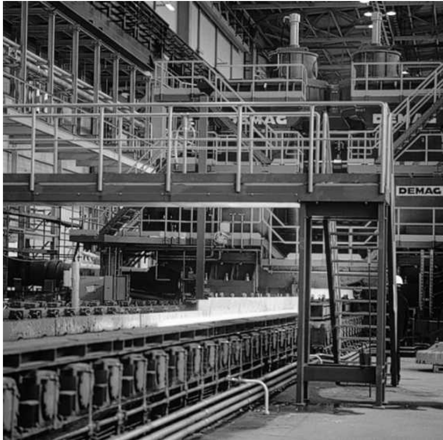
Bild 7: Warmwalzwerk der EKO-Stahl, Vorstrasse [EKO-Stahl]
