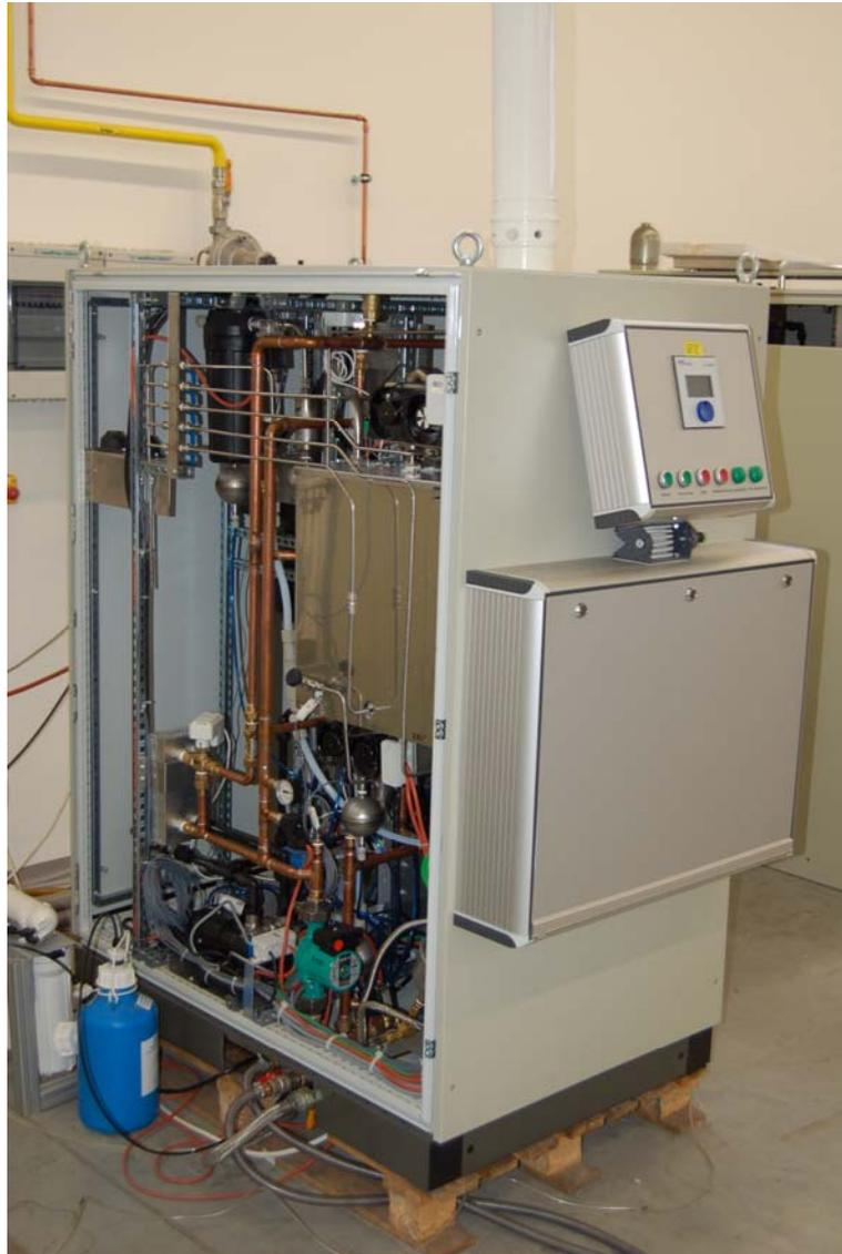
Abbildung II-5: integrierter Dampfreformer
