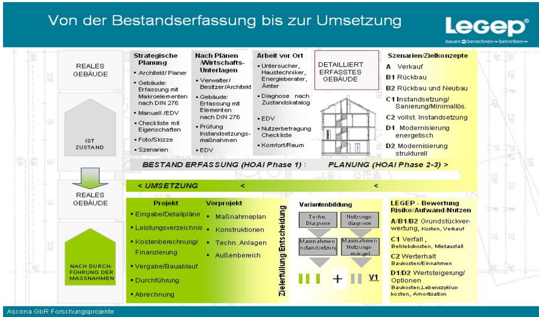
Abb.6-1: Ablauf einer Bestandserfassung – Beurteilung – Maßnahmekonzept – Durchführung
