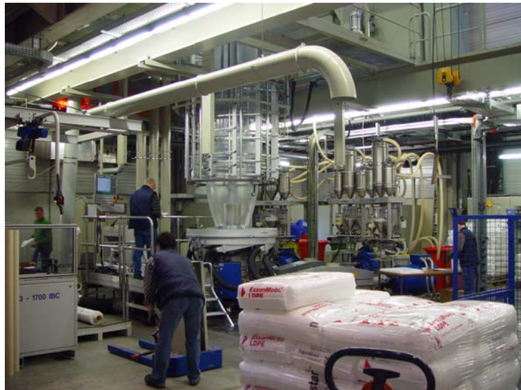
Abbildung 6: Technikumsversuch (man erkennt deutlich, dass der Schlauchquerschnitt deutlich hinter produktions-technischen Dimensionen liegt --> Technikumsversuch!)
