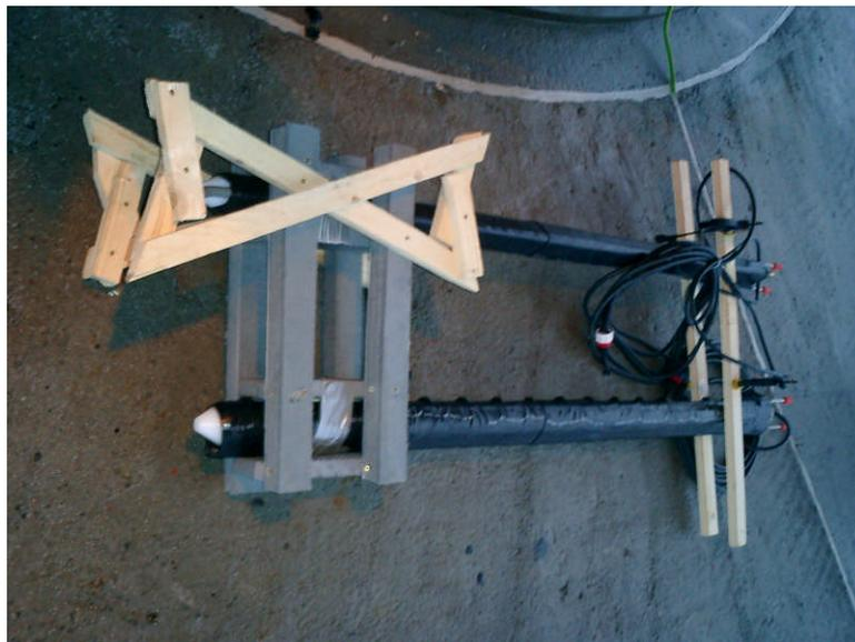
**Abb. 5:** Beispiel einer Messkonfiguration, die im Windpark zum Einbau kam. Die Holzkonstruktion diene als Schutz, damit eine Stromkabelbeschädigung verhindert wird, der Fixierung im Sediment und der Einhaltung eines definierten Abstandes zum Stromkabel.
