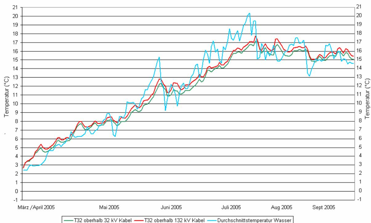
**Abb. 22:** Vergleich der Sedimenttemperaturen direkt oberhalb der Kabel gemessen (Abstand zum Kabel = 25cm) bei a) 33-kV-Kabel und b) 132-kV-Kabel. Desweiteren ist die durchschnittliche Temperatur der Wassersäule dargestellt (Zeitraum hier nur bis zum 20.09.2005.)
