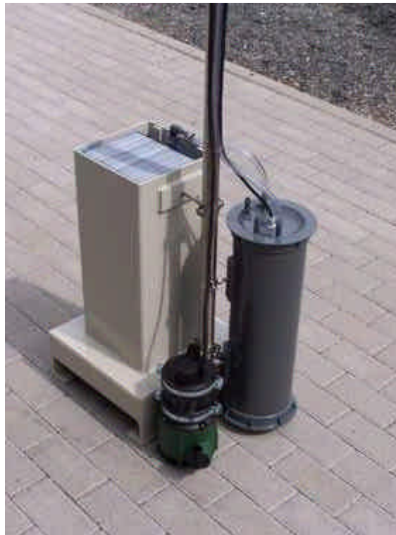
Abbildung 7: Membranfilteranlage mit 10 m 2 Filterfläche inkl. Filtratabzug, Schlammpumpe und Belüfterteller
