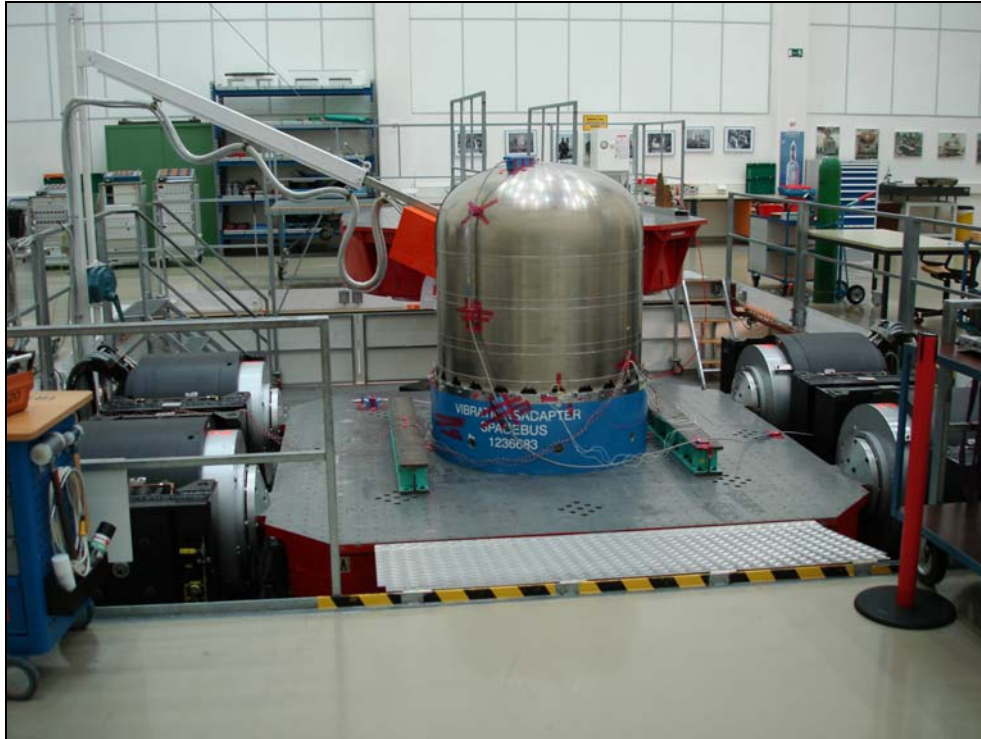
Abbildung 44: Y-Achse in der IABG mbH 300kN Testanlage - Erster Test
