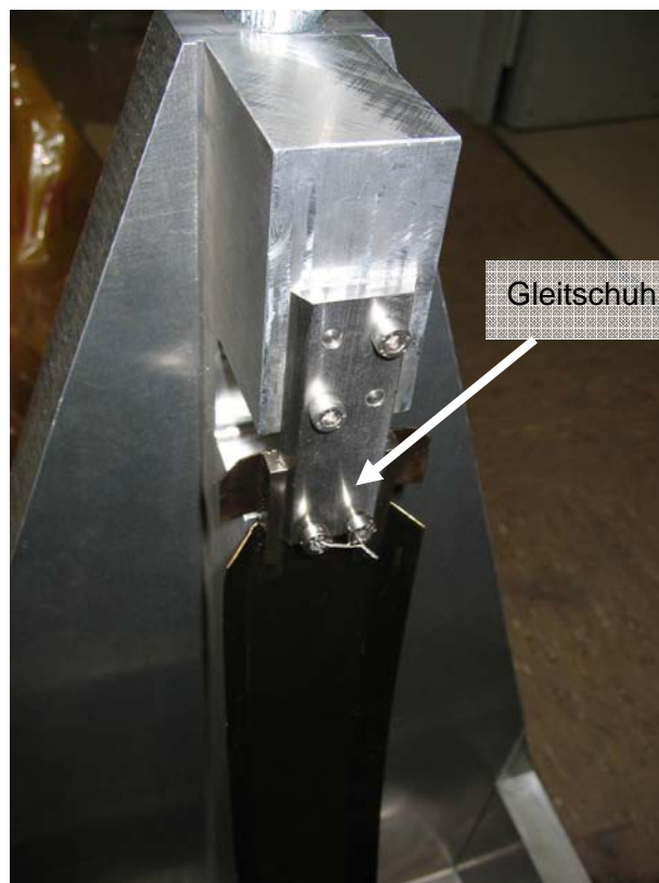
Abbildung 25: Ursprüngliches Design der Leitblech-Fixierung am PRR
