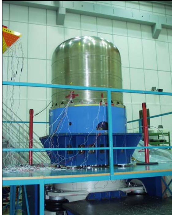
Abbildung 42: Vertikaler Testaufbau: Z-Achse in der IABG mbH 200kN Testanlage
