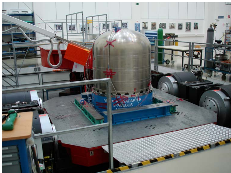
Abbildung 45: Y-Achse in der IABG mbH 300kN Testanlage - Zweiter Test
