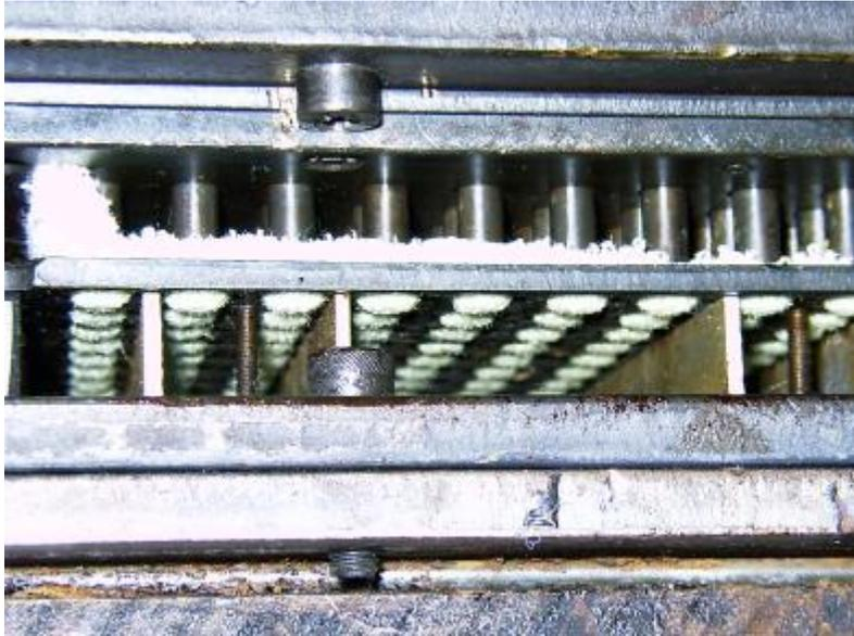
Abb. A4: Tiefziehwerkzeug (geschlossen) mit Prepreg
