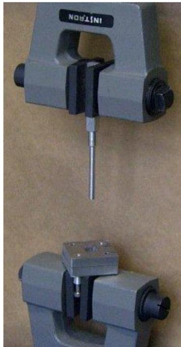
Abb. A6: Versuchsaufbau zur qualitativen Ermittlung der Tiefziehfähigkeit
