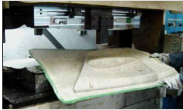
Abbildung 23: Bauteil nach dem Entformen
