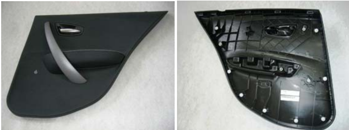
Abbildung 26: 1er BMW Serientürverkleidung (ca. 2120 g)
