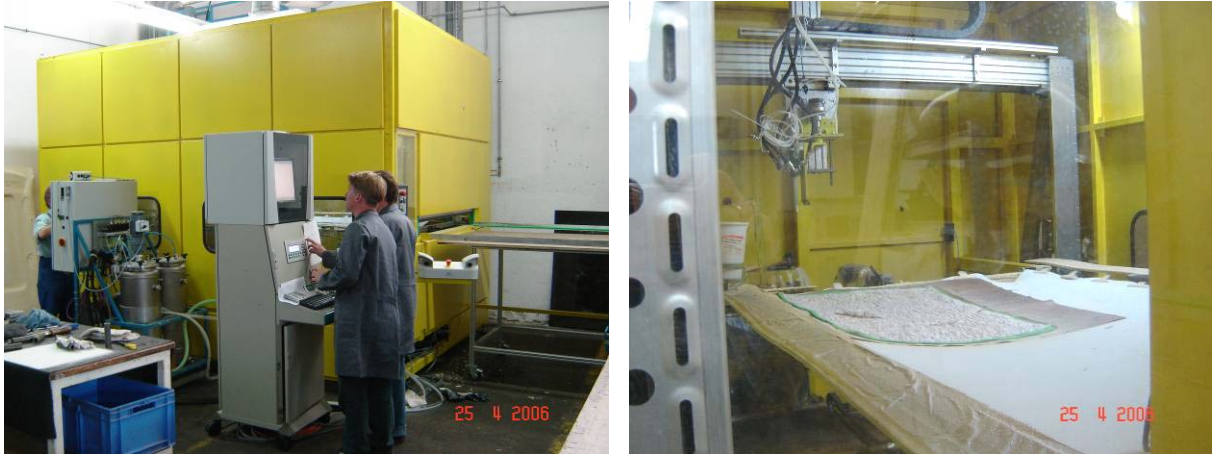
Abbildung 19: Beharzungsanlage in Arbeit. CNC-gesteuerter Sprühauftrag
