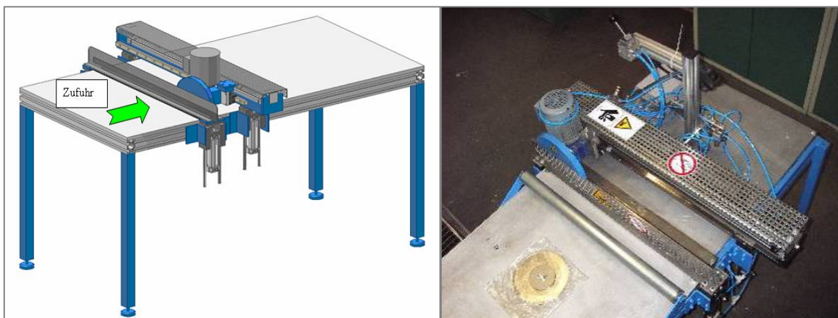
Abbildung 9: Entwurf und Aufbau der (halbautomatischen) Schneideinrichtung
