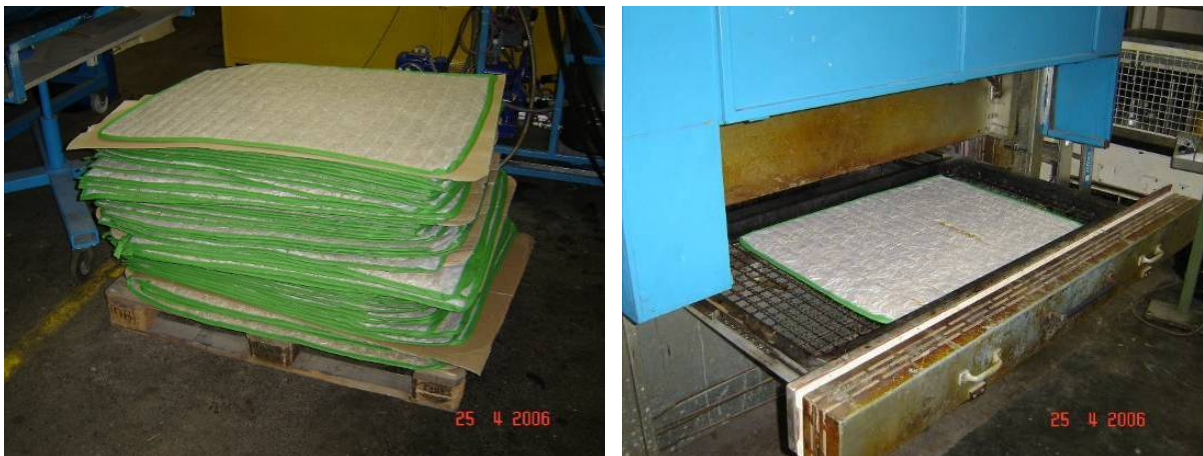
Abbildung 20: Halbzeugzuschnitte. Vortrocknung vor dem Harzauftrag
