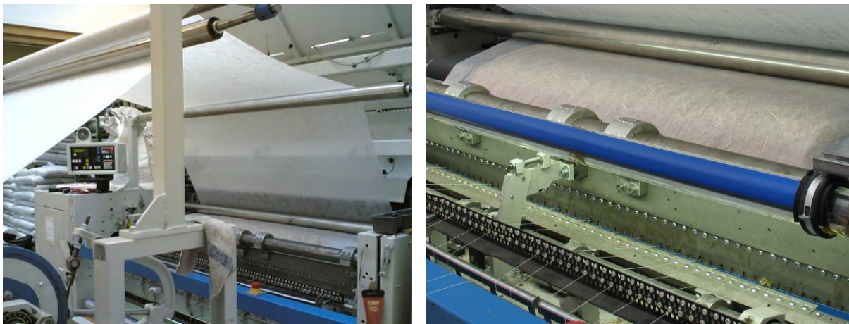
Abbildung 16: Nähtechnische Fixierung des Halbzeugs
