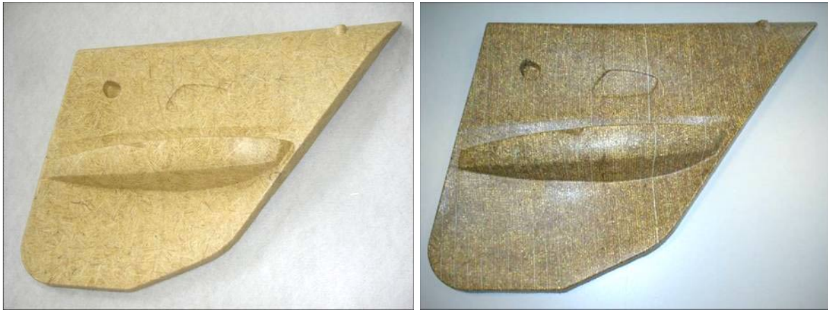
Abbildung 25: Bauteil-Rohträger (links - Kunstfaser-Abdeckvlies, rechts - Jutegewebe)
