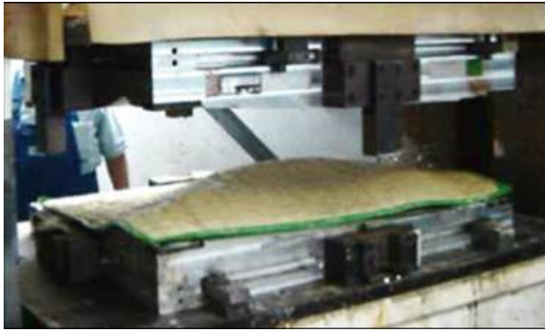
Abbildung 22: Imprägniertes Halbzeug vor dem Pressen
