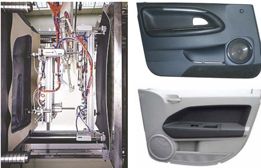
Abbildung 4: Werkzeugansicht und Türverkleidung aus PP und TPE in 2K-Spritzguss
