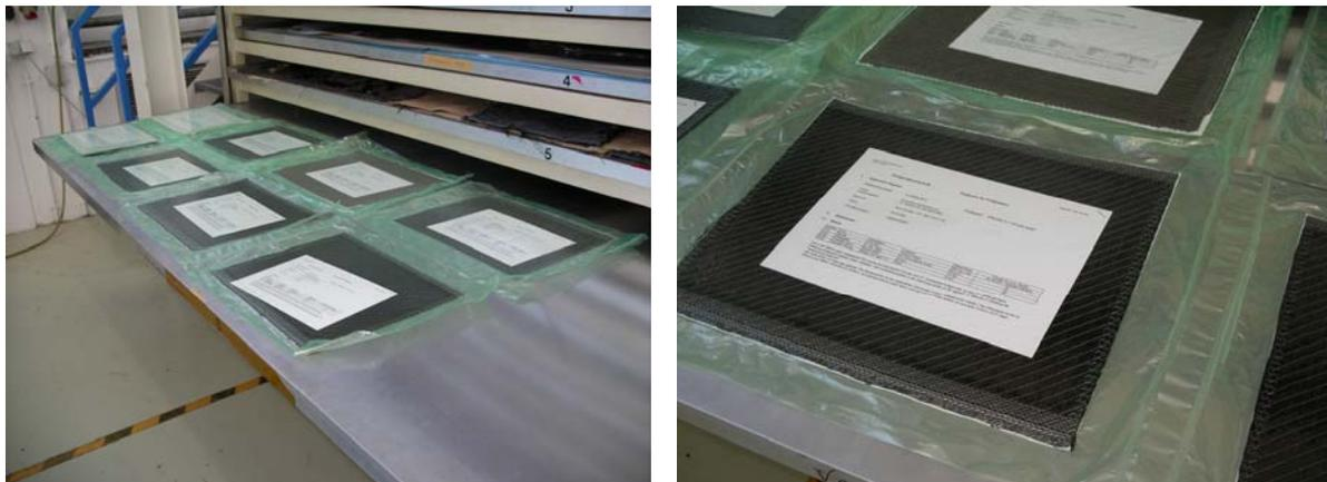
**Abbildung 6: Lagerung der TFP Preforms zur Sicherstellung der Bauteilqualität**
