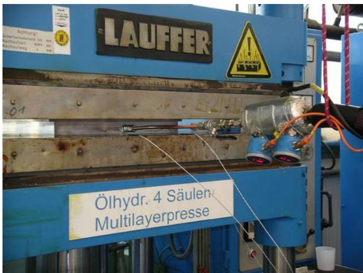
**Abbildung 9: RTM-Presse mit Werkzeug**
