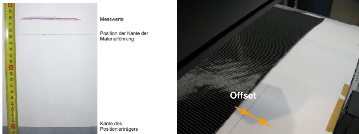
Bild 53: Manuelle Erfassung der Schnittkantenlage relativ zur programmierten Startposition
