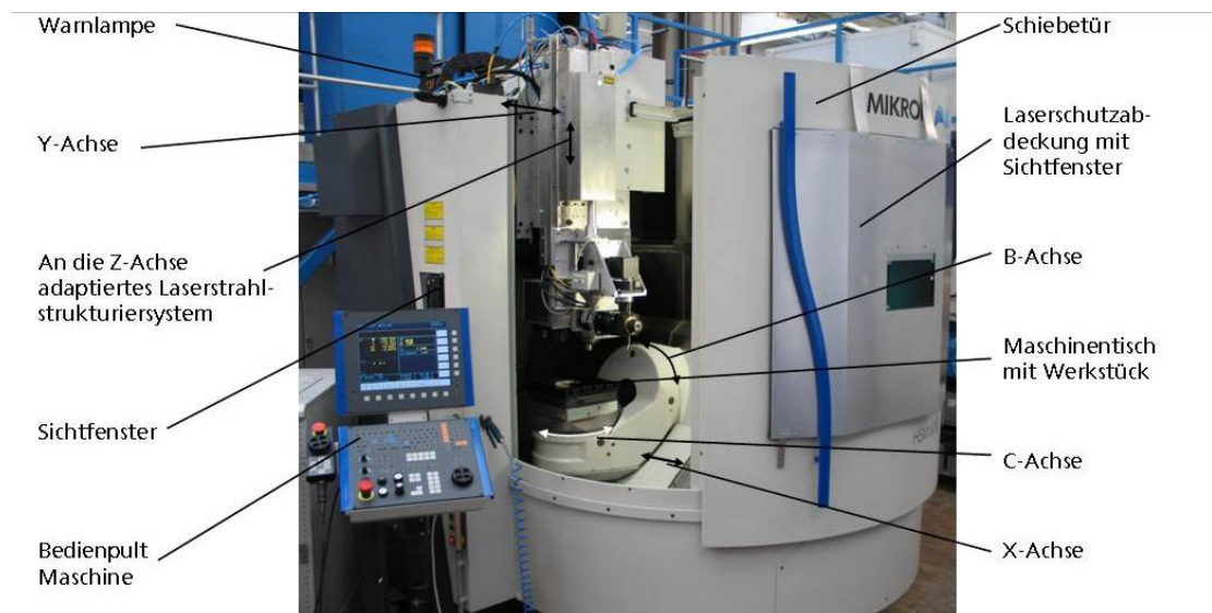
Abb. 25: Integration des Laserstrukturiersystems in ein 5-Achs Basisträger
