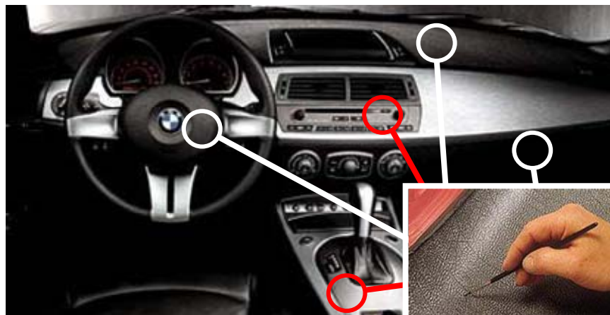
Abb. 1: Narbstrukturen auf Oberflächen im Automobilinnenraum [BMW AG]
