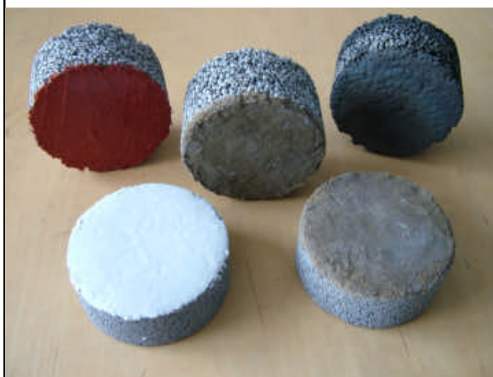
Abb. 7 Nichtmetallisch beschichtete Strukturen
