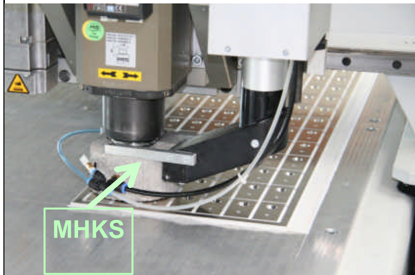
Abb. 16 Fräskopf-Einhausung an einer Hochgeschwindigkeits-Fräsmaschine der Fa. Portatec
