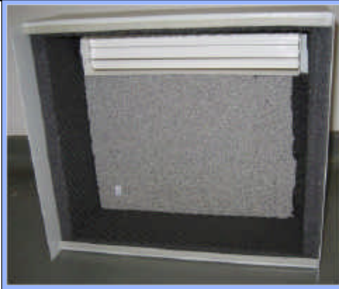
Abb. 13 Absorberelement aus metallischer Hohlkugelstruktur im Ausblaskanal eines Gerätes der Fa. ULT AG
