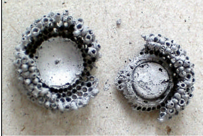
Abb. 8 Entbinderte und gesinterte „Rolly Brushes“
