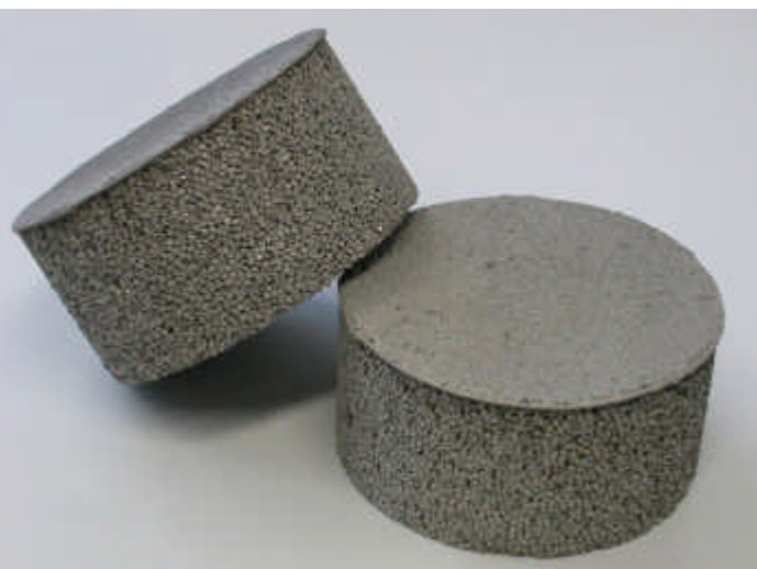
Abb. 6 Durch Lichtbogenspritzen beschichtete Strukturen
