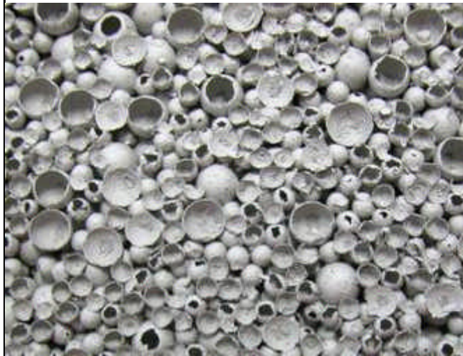
Abb. 5 Nahaufnahme eines geschnittenen Formkörpers, hergestellt aus einer Mischung von 2- und 4-mm-Kugeln (Mischungsverhältnis 1:1)
