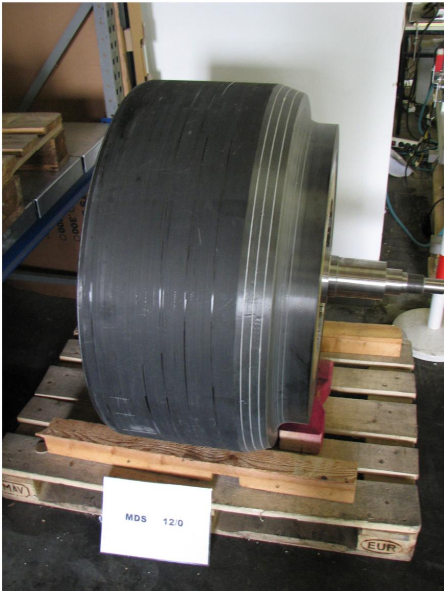
**Bild 13, Rotor des MDS12, mit angepasster Geometrie, fertig montiert mit Welle**
