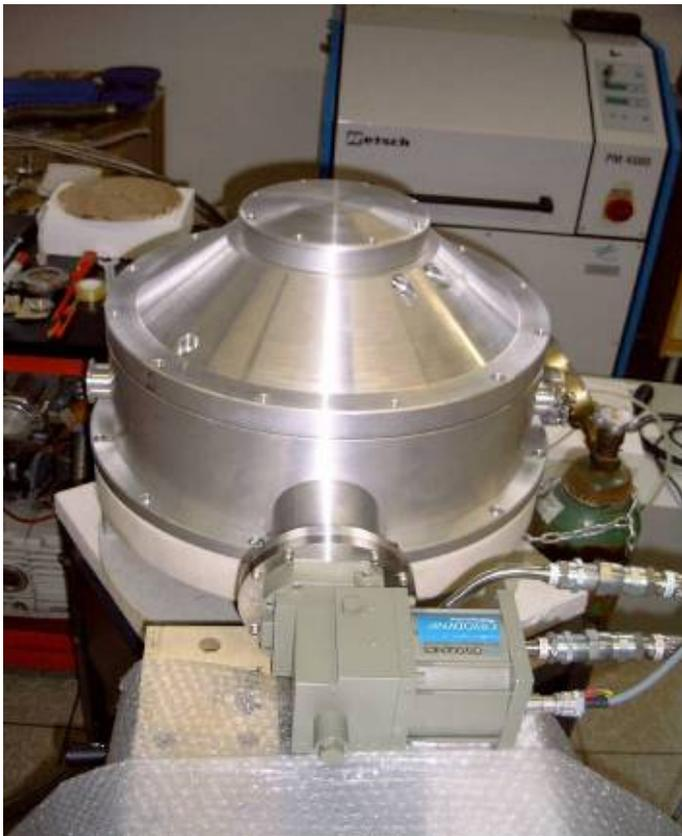
**Bild 14, HTS-Stator mit Original-Gehäuse bei ATZ für Kaltmessungen**
