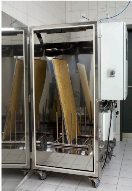
Abbildung 7: Prüfkammer mit einem Volumen von 1 m 3
