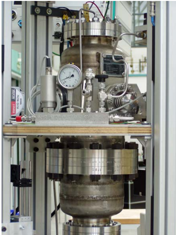
Abb. 2: Druckbehälter mit Brennkammer oben und Tropfenerzeugung und Lift unten
