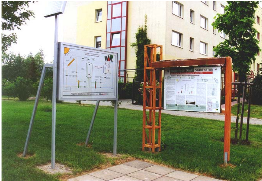
Abb. Ansicht der Anzeigetafel im Freien (energieautark über PV-Modul + Funk-Datenübertragung ) (Foto: TU Ilmenau FG TFD 2000)
