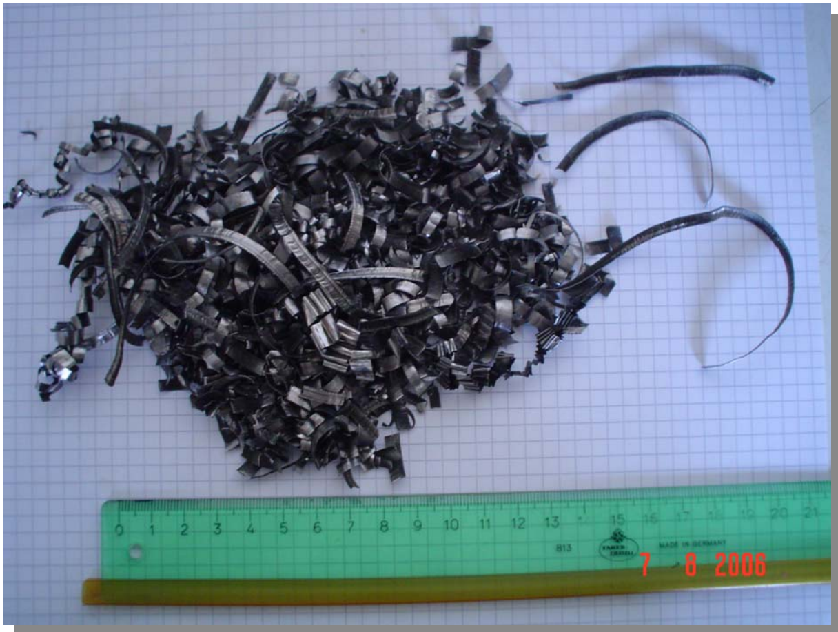
Bild 3: Spänezerkleinerung in der Walzenmühle
