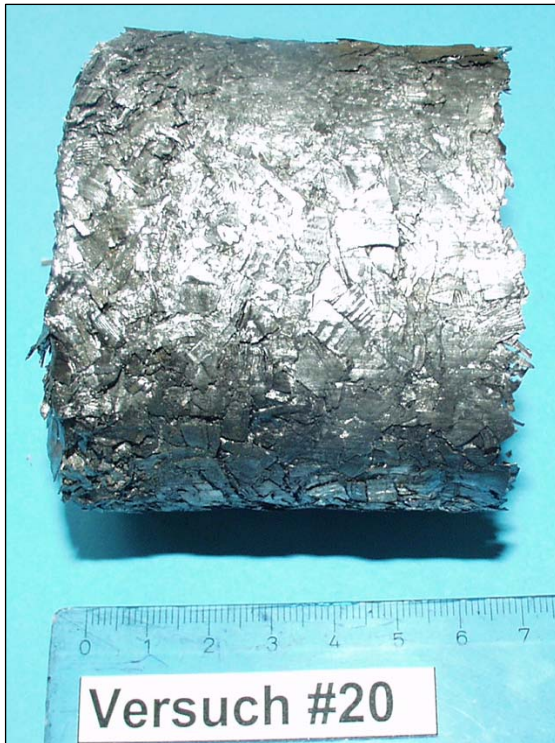
Bild 9.4.5: Presslinge aus Titanspänen und Titanschwammpulver
