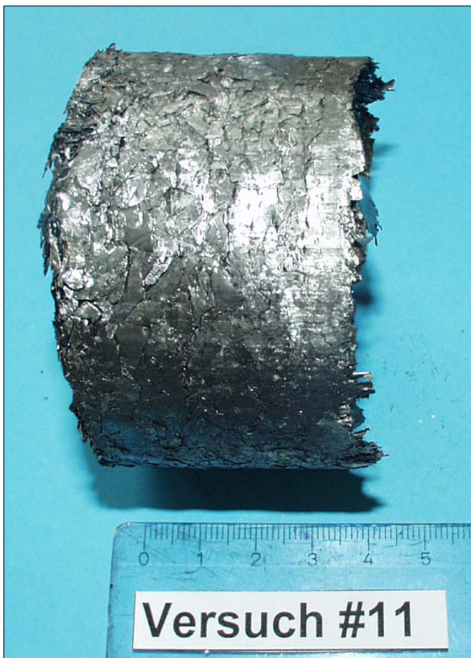
Bild: 9.4.4: Presslinge aus 3.7164 mit (#11) bzw. ohne (#23) Kühlschmierstoff
