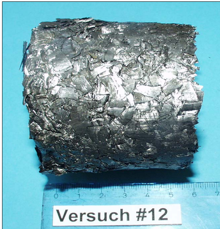
Bild 9.4.3: Titanspänepressling wie zuvor, jedoch h/d = 0,93
