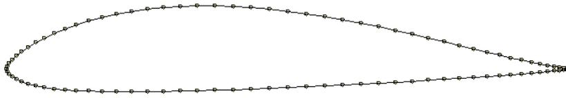
Abbildung 14: Darstellung des Profils FX79W161A.
