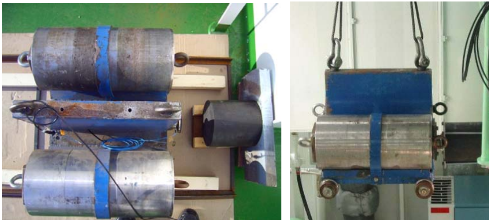
Abbildung A6.4: Anordnung von Erregermasse (auf Schienen geführt oder als Pendel) sowie Gummielement und piezoelektrischer Kraftaufnehmer
