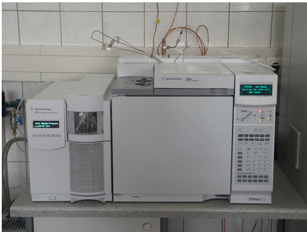
Abbildung 29: GC-MS Gasanalyse-System für die Spurengasmessung
