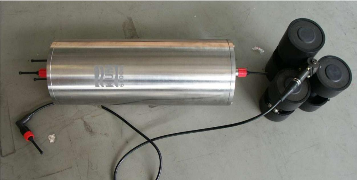
Abb.6: ECHOES Gesamtsystem, bestehend aus Sonarkopf und Elektronikgehäuse.
