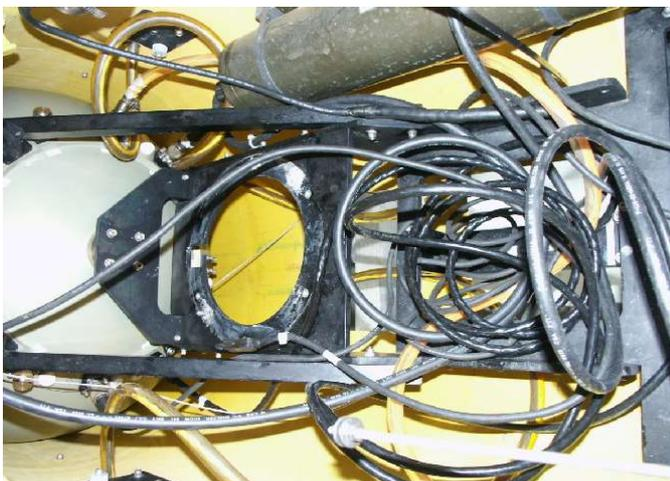
Abb. 7b: Einbaurahmen, montiert am Forward Dome der Druckhülle.
