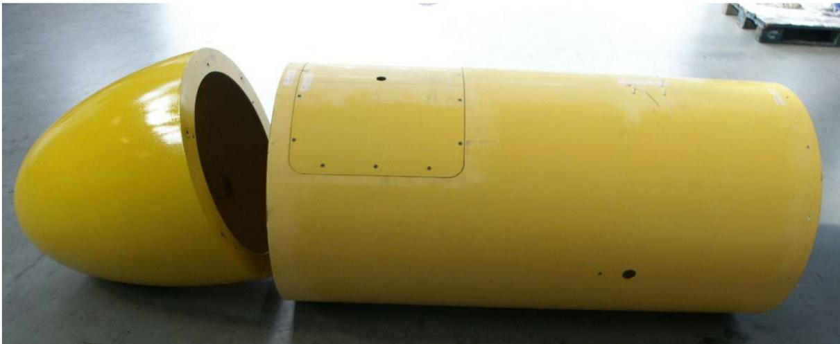
Abb. 7a: Forward-Section (flooded section) und Nose-Section, vor der Installation der Sensoren.
