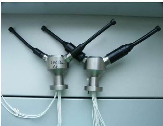
Abb. 9: Titan-Mehrfachadapter für die Kabeldurchführungen, zum Anschluß der einzelnen Sensoren.
