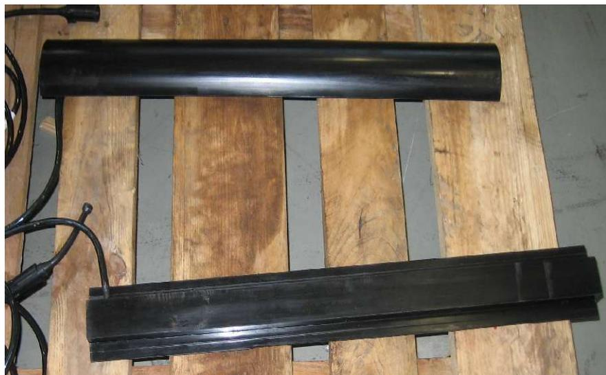
Abb.4: Flach bauende Schwinger Elemente des SIS 1624, zur Montage an der Außenhülle des AUVs SEAL.
