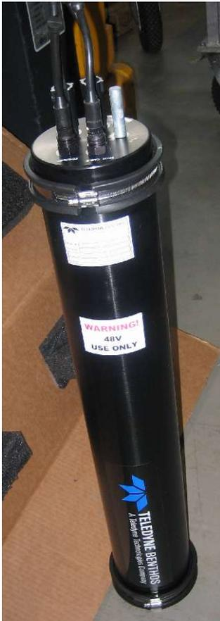
Abb.3: Elektronikgehäuse des BENTHOS SIS 1624.
