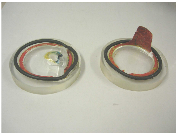
Abb. 52: Ansicht der eingesetzten Plexiglasscheiben nach Testdauer von drei Tagen (Verformungen sind unschwer erkennbar)
