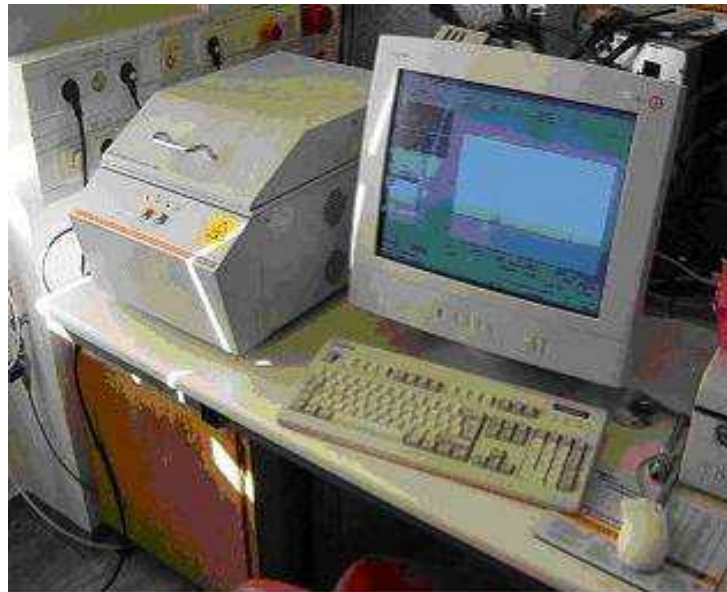
Abb. 44: Spektrometer zum Auffinden von Materialien in der Lösung nach 3-monatiger Testphase
