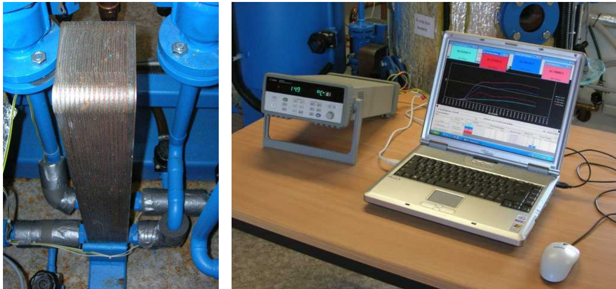
Abb. 17: Versuchsaufbau Temperaturmessung am Lösungswärmetauscher
