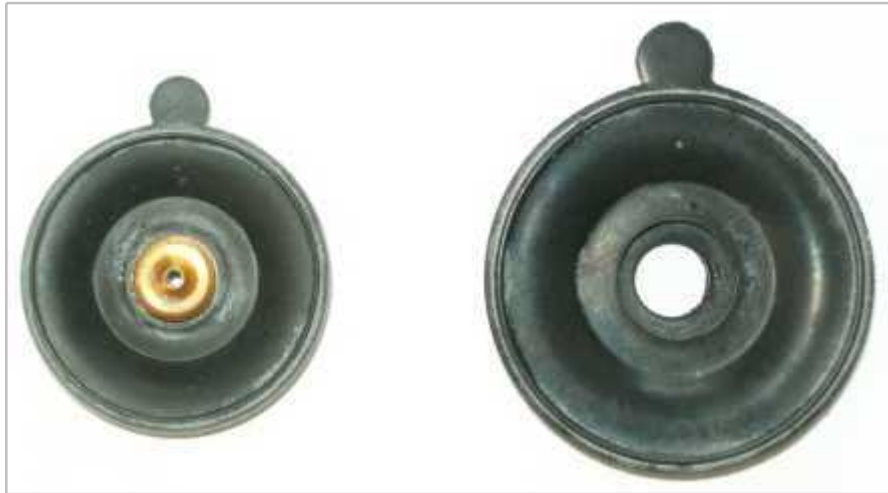
Abb. 53: Membranen nach Versuchsende (links EPDM, rechts NBR)
