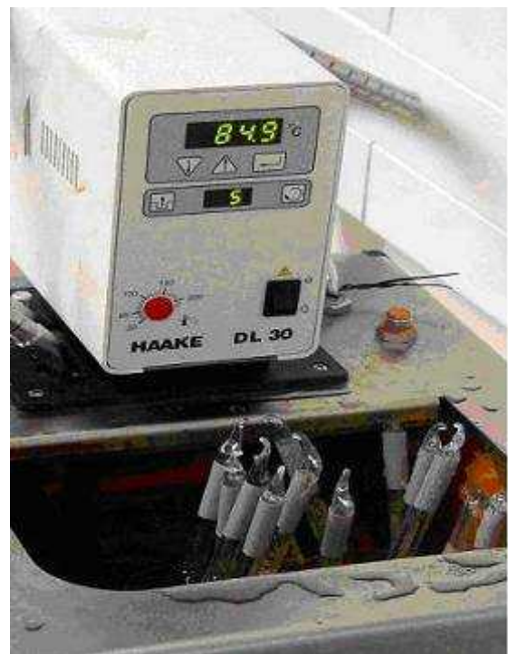
Abb. 41: Die Proben mit verschiedenen Konzentrationen und Temperaturen im Thermostaten
