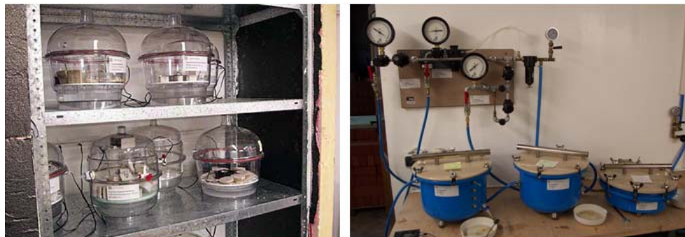
Abb. 2.6: Bestimmung der Feuchtespeicherfunktion (links: Exsikkatoren zur Messung der Sorptionsisotherme, rechts: Druckplattenapparate zur Bestimmung der Saugspannungskurve) am Bauphysikalischen Forschungs- und Entwicklungslabor der TU Dresden
