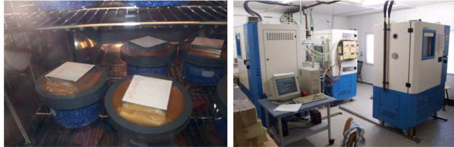
Abb. 2.9: Bestimmung des Wasserdampfdiffusionskoeffizienten (links: Behälter zur Probeninstallation im Klimaschrank, rechts: Klimaschränke) am Bauphysikalischen Forschungs- und Entwicklungslabor
