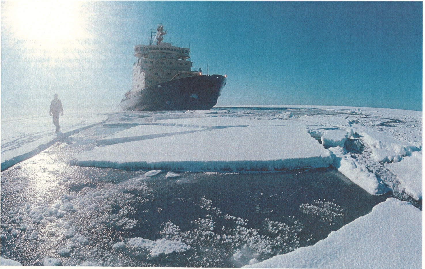
Mühsal im Frost: Die Trümmer des aufgebrochenen Packeises frieren bei den tiefen winterlichen Temperaturen am Polarkreis rasch wieder zusammen. Schiffe mit einem speziell geformten Bug sollen das verhindern (oben: der finnische Eisbrecher „Sisu“).
