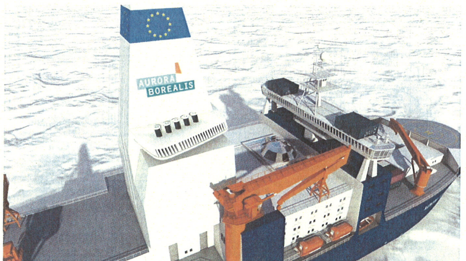
Der große Bohrturm, in dem alle Bohrungen wettergeschützt ausgeführt werden können, prägt das äußere Erscheinungsbild des Schiffes
