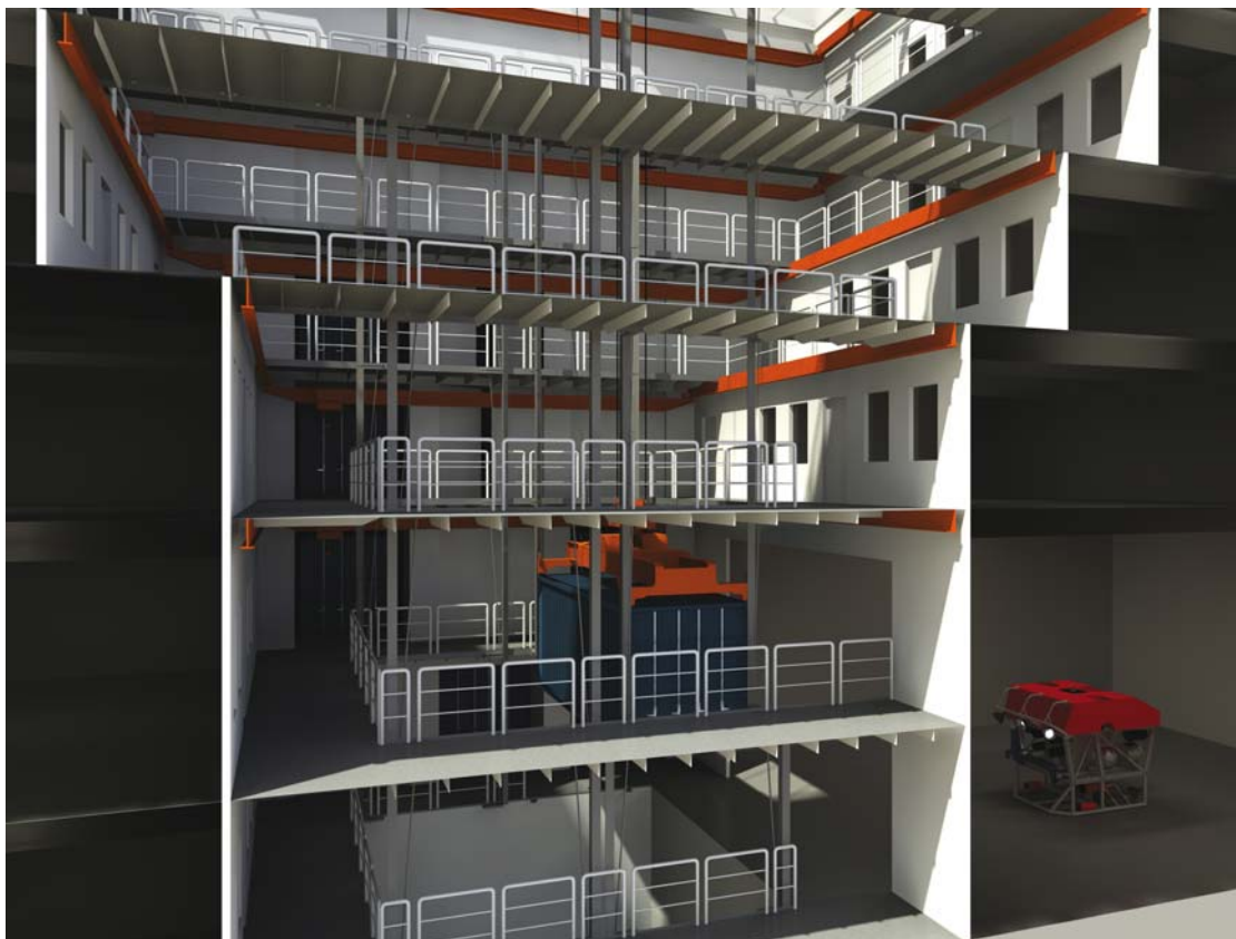
Abb. 11: Innovatives Atrium-Konzept mit Forschungs- und Beschickungsmöglichkeiten aus allen Decksebenen.
