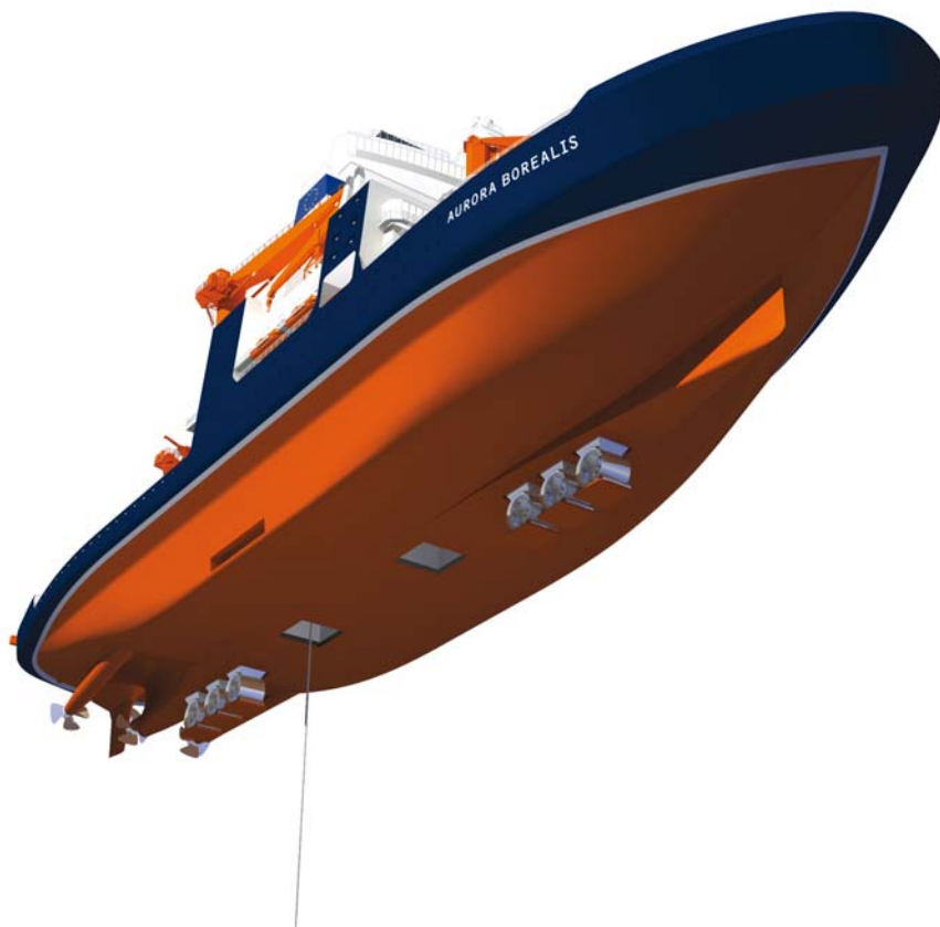
Abb. 7: Spezielle Rumpfform mit Vortriebs- und Querstrahleinheiten sowie den beiden Moon Pools.
