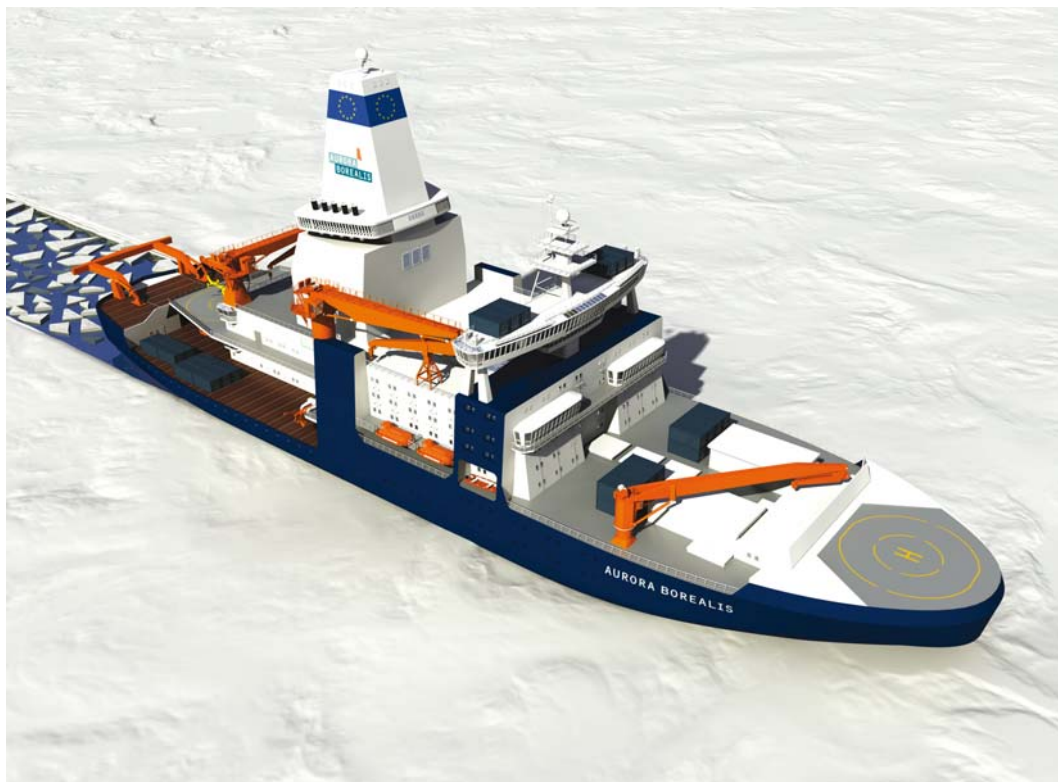
Abb. 1: AURORA BOREALIS: Kombination eines schweren Eisbrechers, Bohrschiffes und Mehrzweck-Forschungsschiffes.
