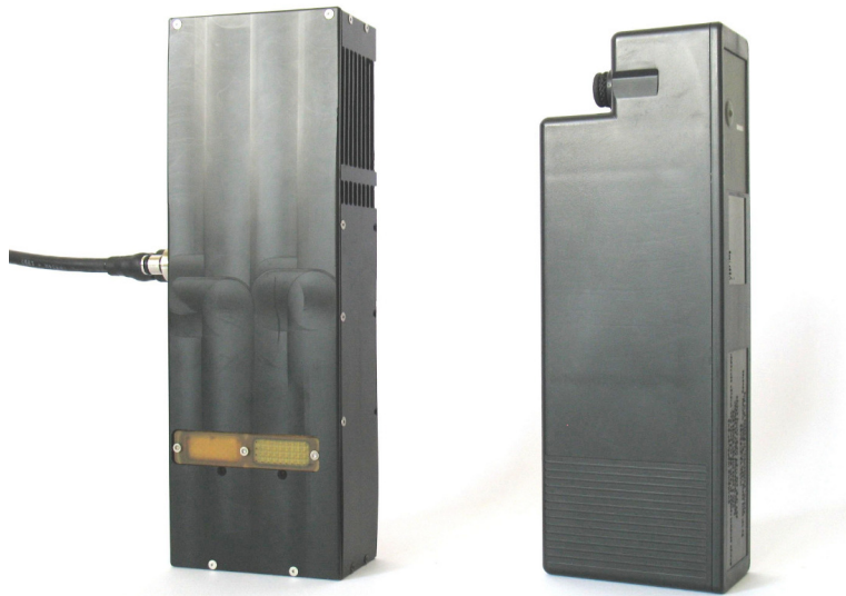
Abb. 2.5: Miniaturisiertes Kompaktsystem im Vergleich zu herkömmlicher Li-Ionen-Batterie (rechts)
