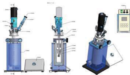
Reaktorsystem für Auslagerungsversuche unter Druckbedingungen
