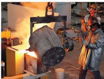
Horizontaler Schleuderguss in rotierender Kokille
