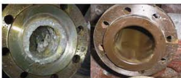
Unbeschichtetes Rohr im Vergleich zu TK®-216 Beschichtung
